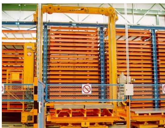
Fig. 2.13 – Transtocador, de duplo mastro, para chapas de metal, longas
