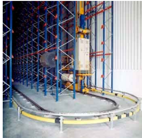
Fig. 2.10 - Mudança de ala, através de carris das alas ligados em curva em curva
