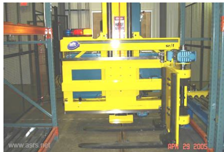
Fig. 2.7 - Transtocador , com possibilidade de rotação dos garfos
