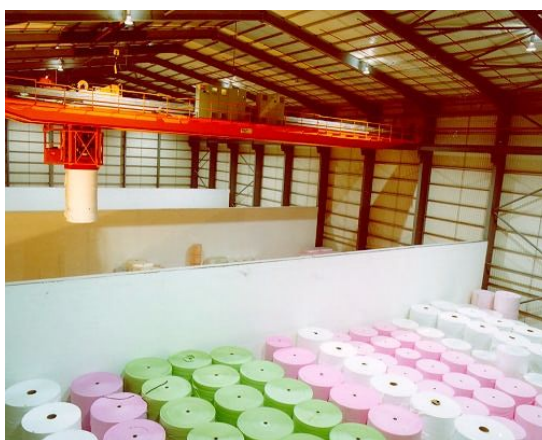
Fig. 2.12 – Ponte rolante, para manipular cargas extremamente pesadas – Ex: bobinas de papel
