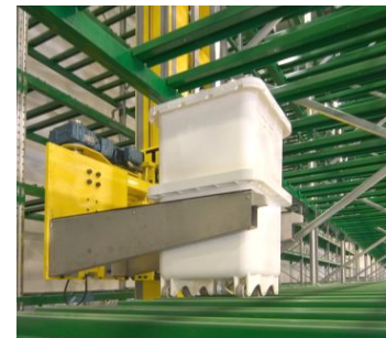
Fig. 2.8 - Transtocador , na fase de agarrar dois Caixaes
