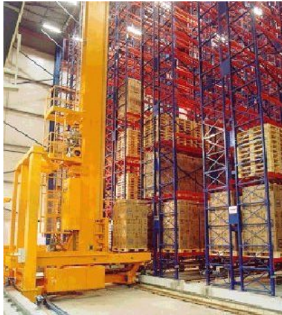
Fig. 2.9 - Mudança de ala, através de um carro de transferência
