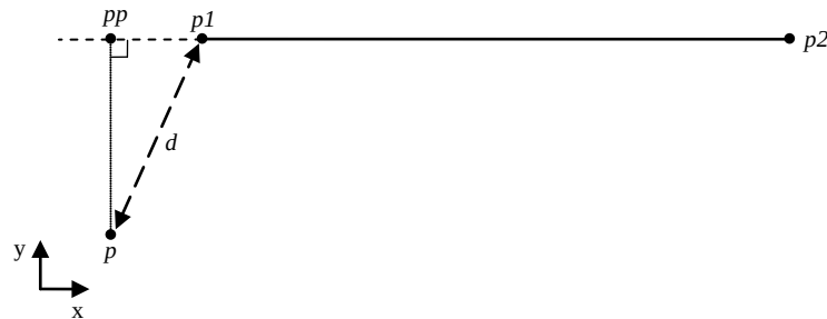
Figura 4.3: Distância de um ponto a uma linha rodada
