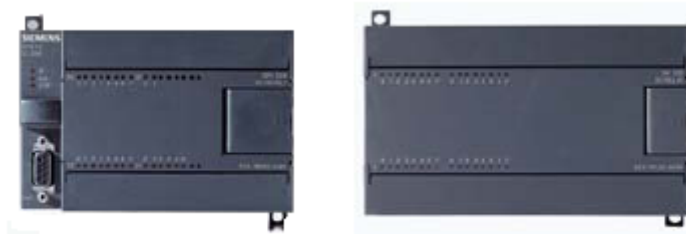
Figura 80 - PLC e módulo de expansão S7-200 CPU 224
