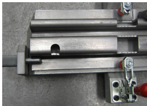
Figura 30 - Pormenor da fixação, com grampos mecânicos
