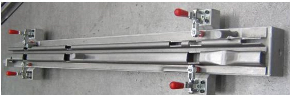
Figura 29 - Fotografia do perfil, fixo por grampos mecânicos
