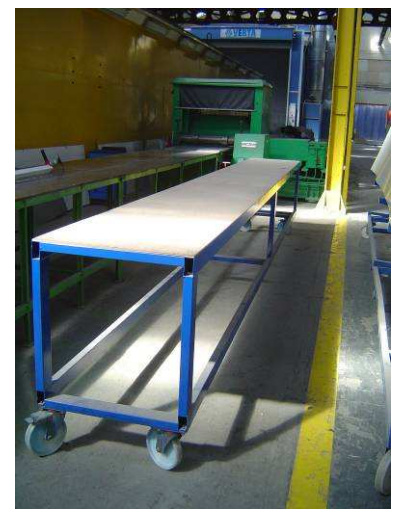
Figura 41 - Melhoria da pré montagem do tejadilho (1- situação inicial ; 2- montagem da nova mesa ; 3- nova mesa)
