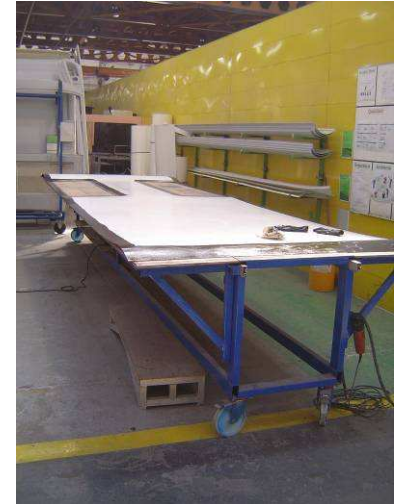
Figura 41 - Melhoria da pré montagem do tejadilho (1- situação inicial ; 2- montagem da nova mesa ; 3- nova mesa)
