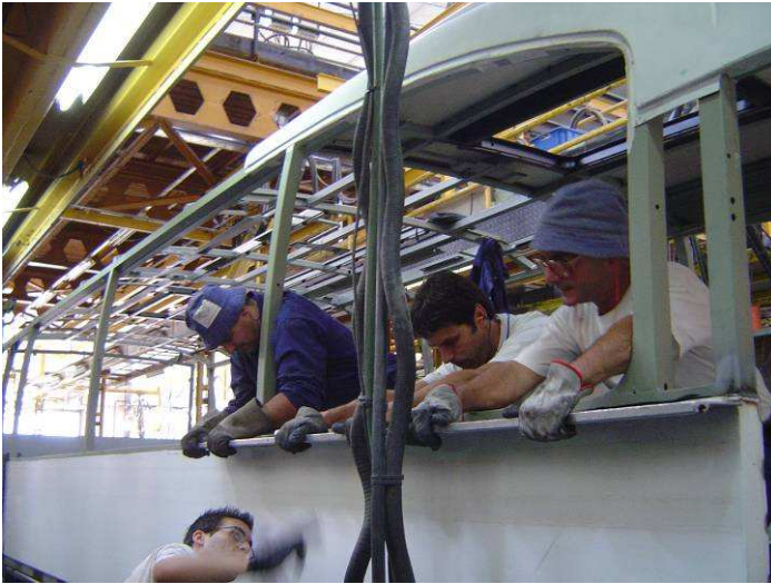
Figura 27 - Colocar Painel (situação Inicial)
