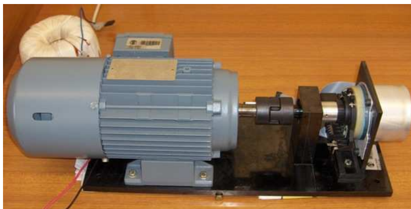
Figura 5.18 - Motor DC à esquerda e o motor síncrono de ímãs permanentes à direita.
