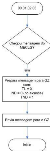
Figura 4-9 - Fluxograma de funcionamento do GL, Fluxograma de funcionamento do GL, leitores de proximidade ou contacto
