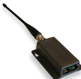
Figura 2-5 – Leitor RFID com antena incorporada
