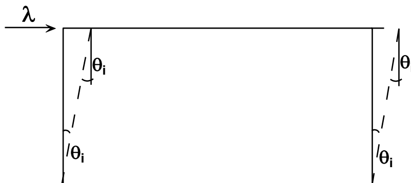
Fig. 4.9. – Aplicação do Princípio dos Trabalhos Virtuais.
