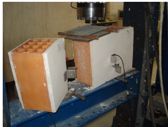
Figura 132 - Modo de rotura PJHA
