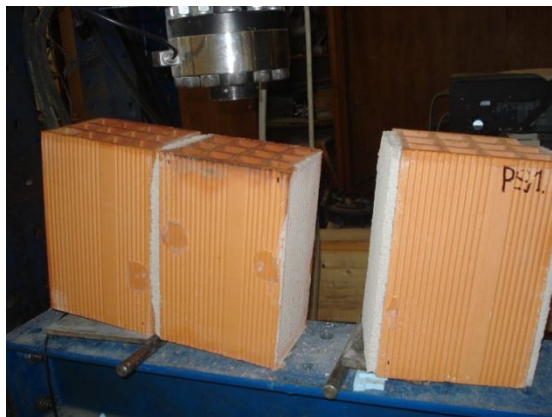
Figura 126 - Modo de rotura PS
