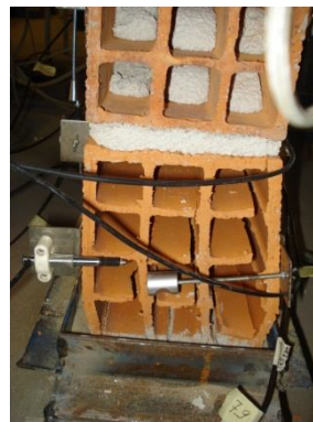
Figura 78 - Modo de rotura PS
