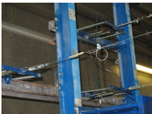
Figura 163 - Suporte rígido para instrumentação
