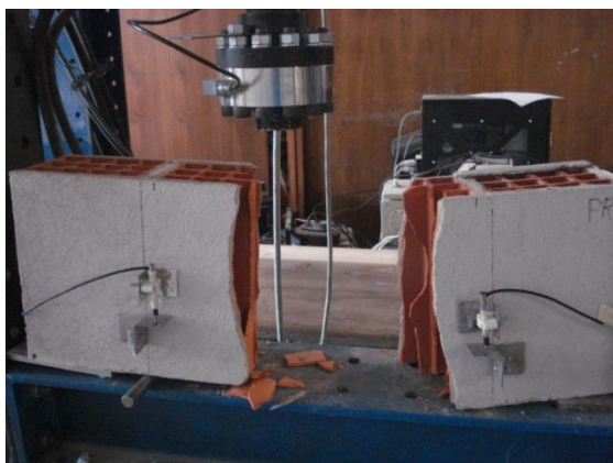
Figura 127 - Modo de rotura PRS
