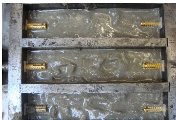
Figura 58 - Aplicação de buchas para a colocação de pernos nos topos dos provetes
