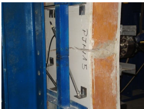
Figura 116 – Modo de rotura PJHA
