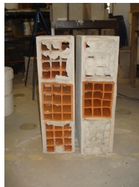
Figura 113 - Modo de rotura PRS
