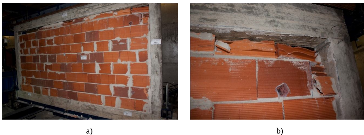
Figura 183 – Resultado final do ensaio: a) vista geral; b) colapso parcial das unidades do canto superior esquerdo
