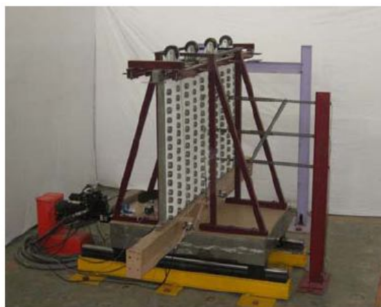
Figura 26 - Esquema de ensaio usado no ensaio para fora do plano [26]
