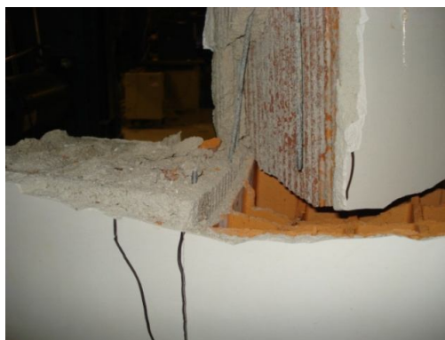
Figura 117 – Modo de rotura PJHA
