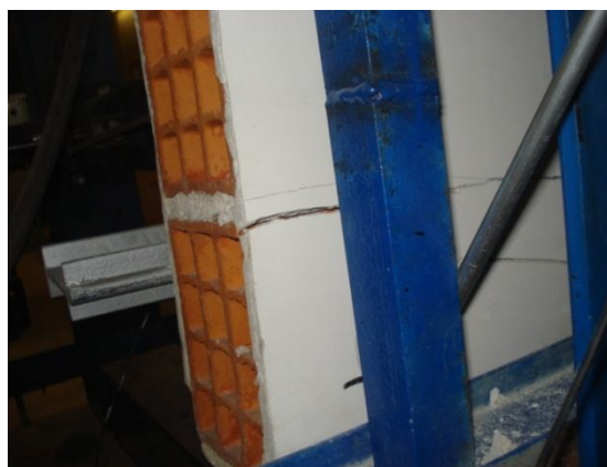
Figura 101 - Modo de rotura PJHA
