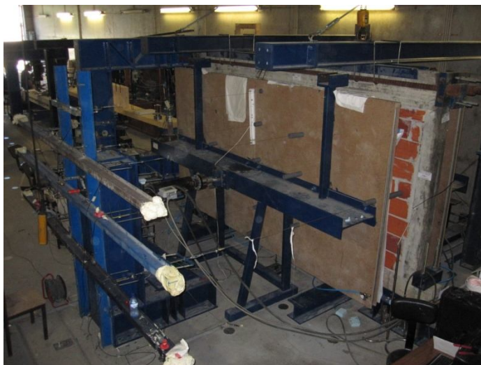
Figura 178 - Estrutura geral para ensaio para fora do plano
