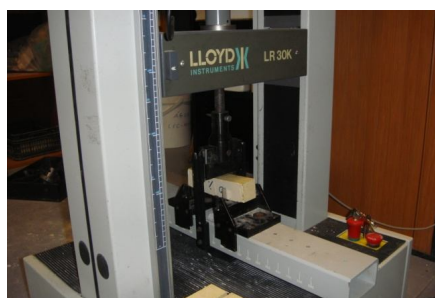
Figura 50 - Molde utilizado para ensaios de flexão
