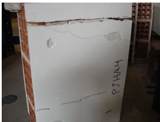
Figura 100 - Modo de rotura PJHA
