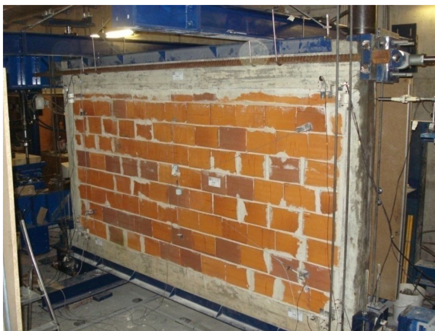
Figura 151 - Painel de alvenaria instrumentado para a realização no ensaio no plano
