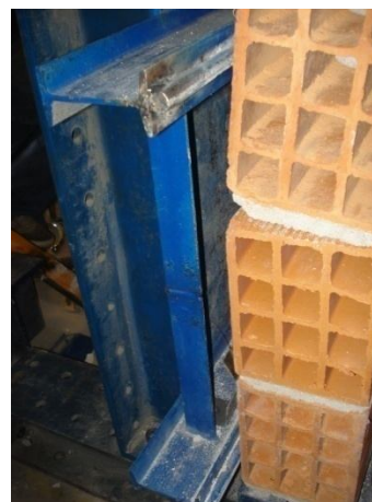
Figura 95 - Modo de rotura dos provetes simples
