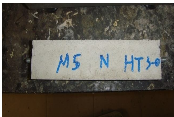
Figura 57 - Pernos metálicos nos topos dos provetes para a medição da retracção
