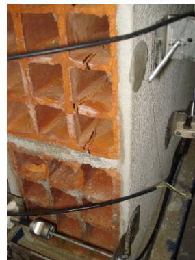
Figura 80 - Modo de rotura PRS
