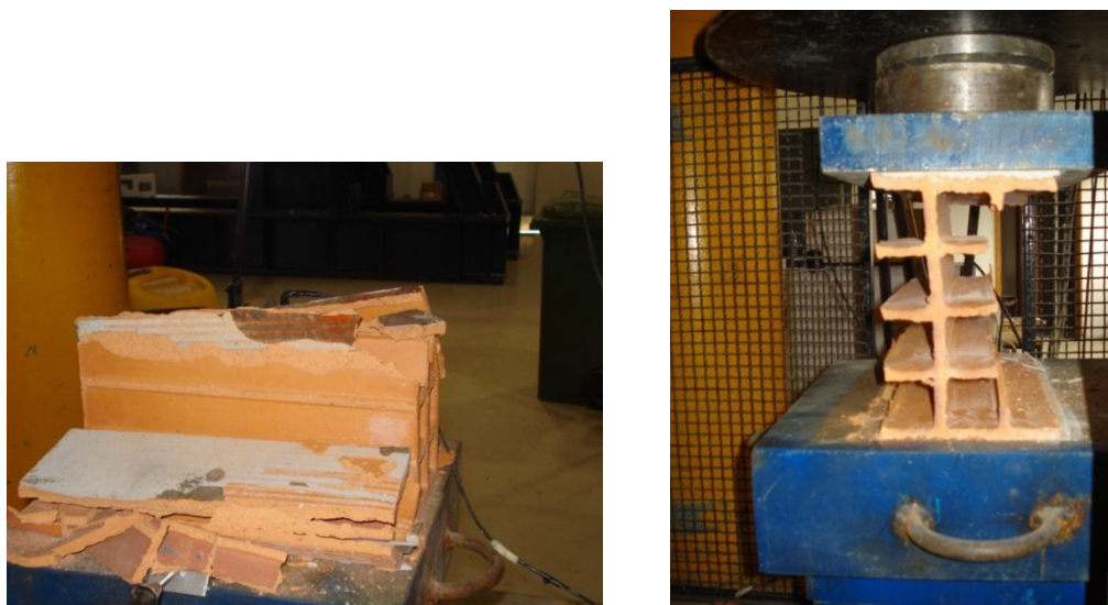
Figura 49 - Modo de rotura obtido
