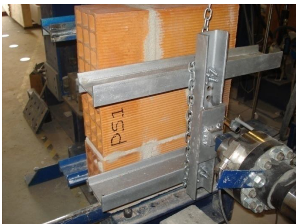
Figura 94 - Proвете simples sujeito a flexão paralela às juntas de assentamento
