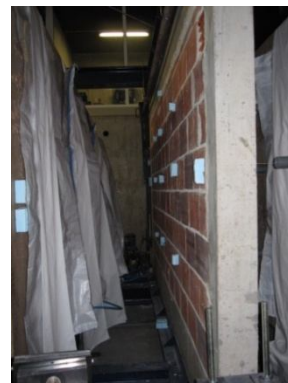
Figura 161 - Airbags para distribuição de carga
