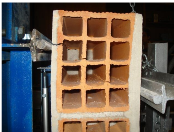
Figura 96 - Modo de rotura PRS
