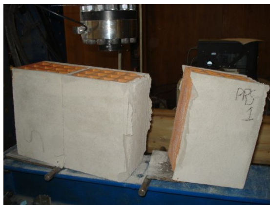
Figura 128 - Modo de rotura PRS
