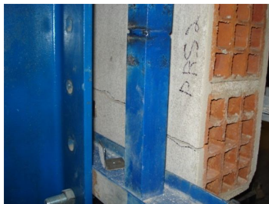
Figura 97 - Modo de rotura PRS
