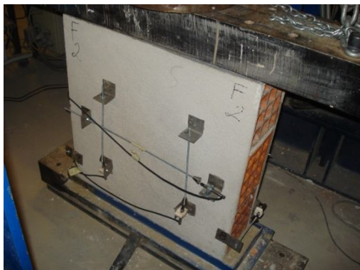
Figura 79 - Provede de reboco simples sujeito ao ensaio de compressão
