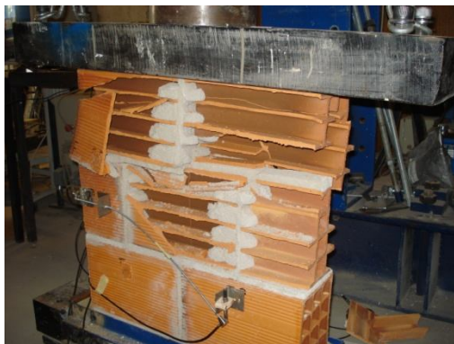
Figura 77 - Modo de rotura PS
