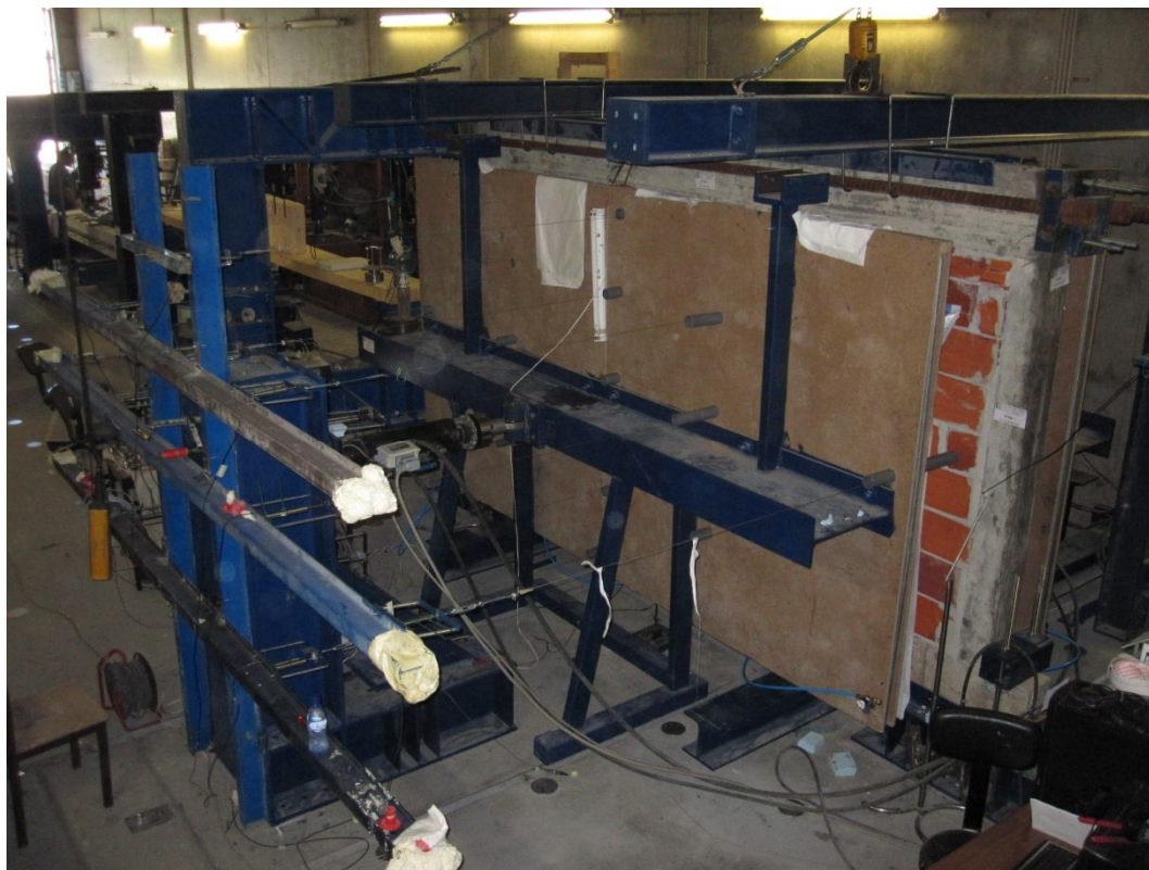
Figura 165 - Estrutura geral para ensaio para fora do plano
