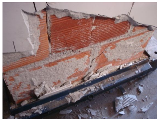
Figura 84 - Modo de rotura PJHA
