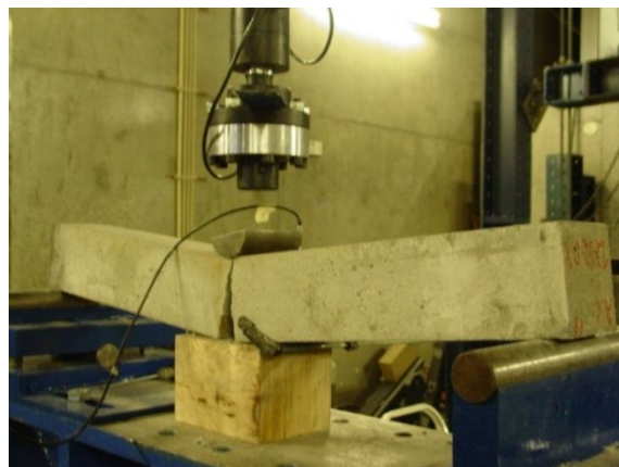
Figura 62 - Plano de rotura no ensaio de determinação da energia de fractura
