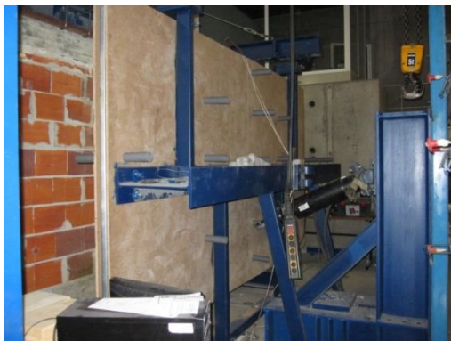
Figura 160 - Infra-estrutura de transmissão de carga
