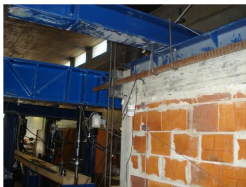
Figura 145 - Estrutura para transmissão de deslocamentos alternados
