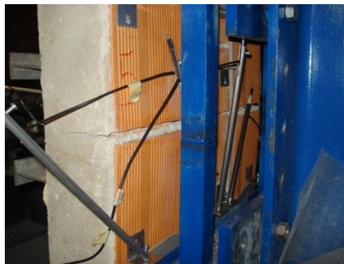
Figura 111 - Modo de rotura PS
