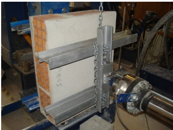
Figura 98 - Provete de reboco armado sujeito a flexão paralela às juntas de assentamento
