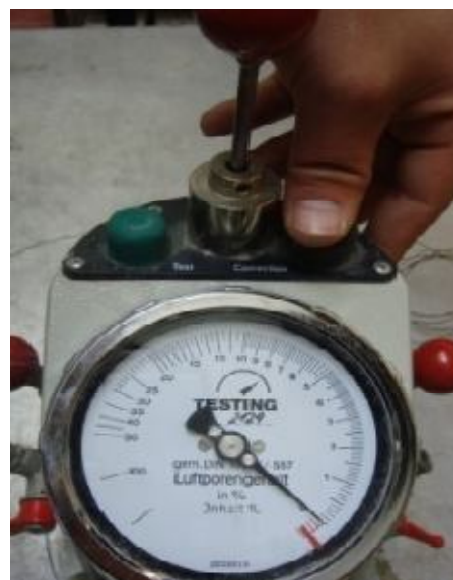
Figura 55 - Ensaio de determinação do teor em ar das argamassas frescas
