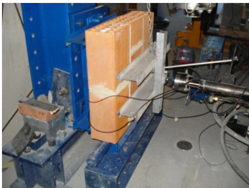
Figura 110 – Provede simples sujeito a flexão perpendicular às juntas de assentamento
