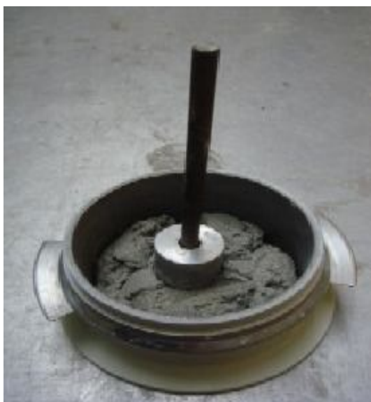
Figura 54 - Compactação da argamassa para o ensaio de determinação do teor em ar
