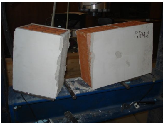
Figura 131 - Modo de rotura PJHA
