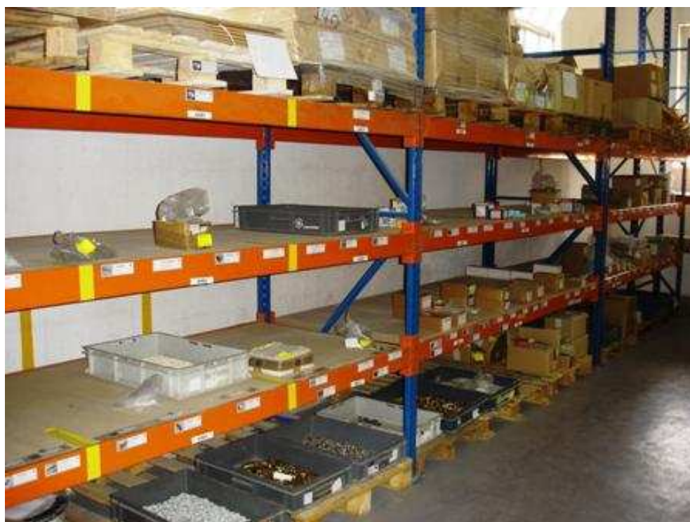
Figura 75 – Identificação de todos os componentes na estante e criação de locais fixos de armazenagem
