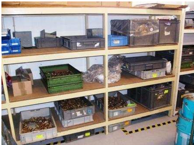
Figura 54 – Ausência de identificação de material e de espaços fixos de armazenagem
