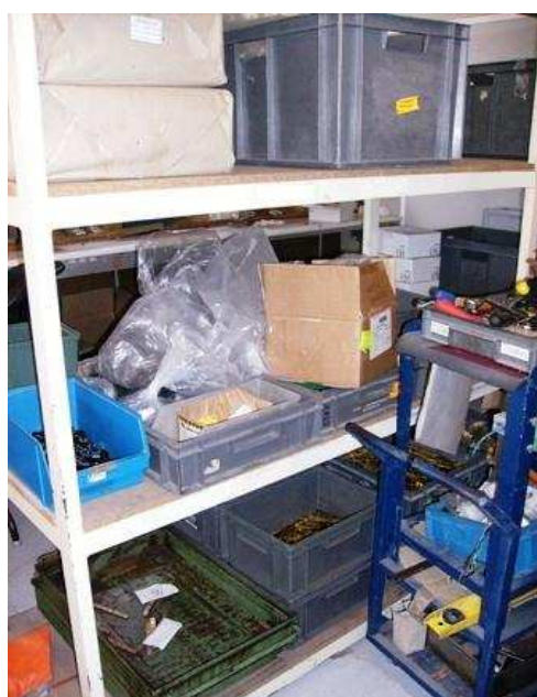
Figura 14 – Situação de materiais diferentes alocados no mesmo contentor sem qualquer identificação.
