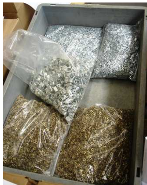
Figura 57 – Alocação de materiais diferentes e sem qualquer identificação num mesmo contentor
