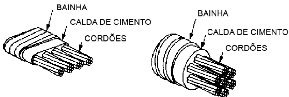
Figura 2.10 – Bainha e cordões de pré-esforço (sistema aderente)
