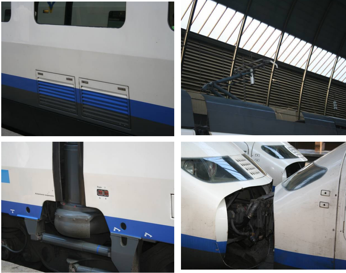
Fig. 23 - Zonas onde o ruído aerodinâmico é mais significativo: ventiladores (superior esquerda); pantógrafo (superior direita); ligação entre carruagens (inferior esquerda); ligação entre locomotivas (inferior direita) [Fotos do autor].
