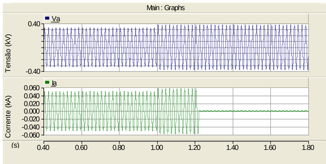
Figura 52 - Tensão e corrente na fase de defeito
