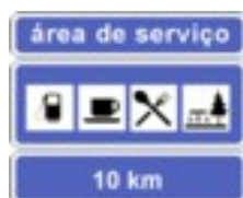
Figura 4.4 – Sinal vertical de pré-sinalização – I4a
