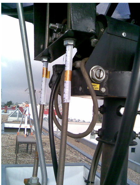
Figura 5.9 - Escalas milimétricas de auxílio à calibração da antena
