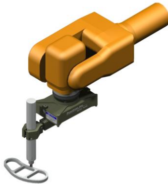
Figura 1.16 - Simulação de robô industrial a executar operação de acabamento com controlo de força passivo ( http://www.pushcorp.com/Products/afd50.htm )
