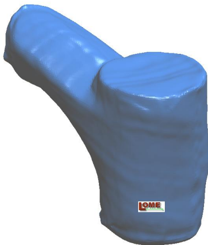
Figura 3.17 - Modelo final obtido pelo DAVID Laserscanner do corpo da torneira
