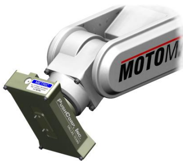
Figura 1.14 - AFD51 instalado em robô
