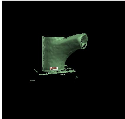
Figura 3.16 - Imagem obtida pela fusão de duas faces do corpo da torneira
