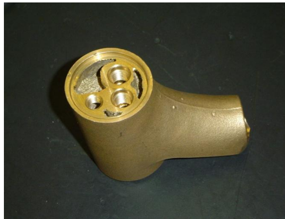
Figura 3.4 - Face inferior do corpo da torneira pela qual é realizada a fixação no robô
