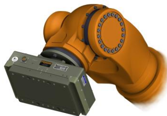
Figura 1.12 - AFD1100 montado em robô industrial ( http://pushcorp.com/Products/afd1100.htm )
