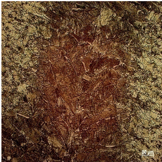
Figura 41 - Zona de fusão e ZTA do aço DC 04 soldado por Fibre Laser. Nital 2%.
