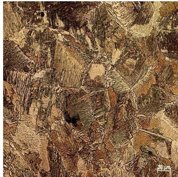
Figura 42 - Zona de fusão do aço QSTE 340 soldado por Fibre Laser. Nital 2%.
