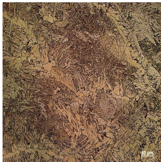
Figura 40 - Zona de fusão do aço QSTE 340 soldado por processos GMAW. Nital 2%.
