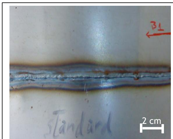
Figura 21: Cordão de soldadura B1
