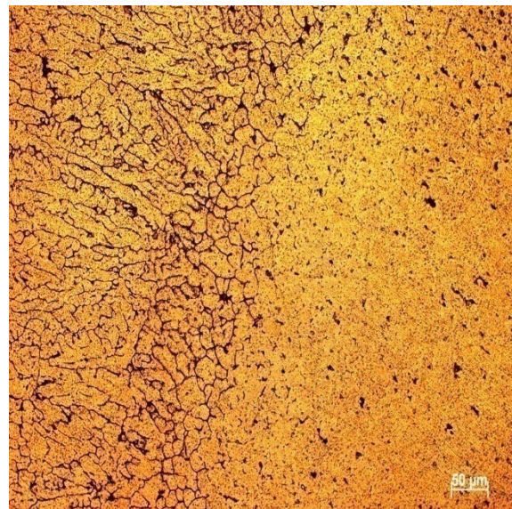
Figura 46 - Zona de fusão e ZTA da liga de alumínio EN AW 5052 ligada por soldadura GMAW. Reagente de Keller.
