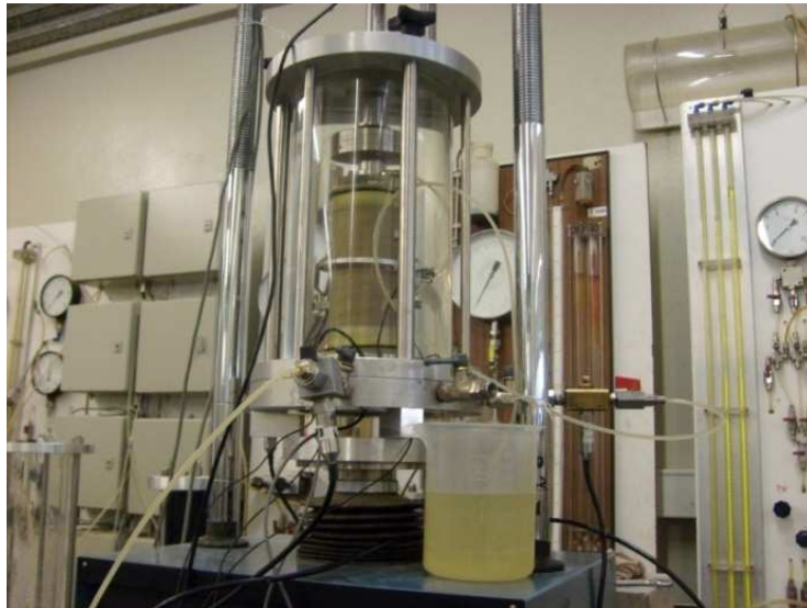
Figura 4. 13 – Percolação do solo em estudo.
