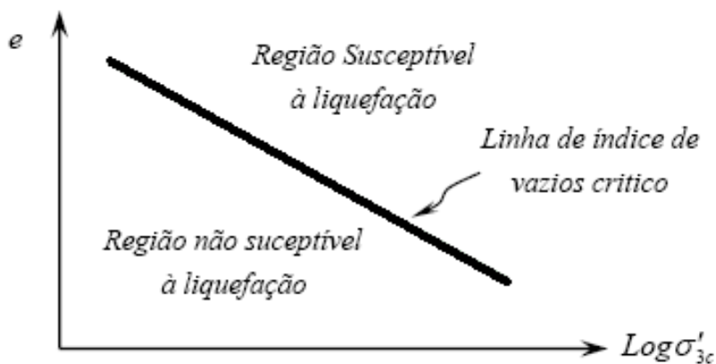
Figura 2. 21 – Linha de índice de vazios crítico (Bedin, 2008).
