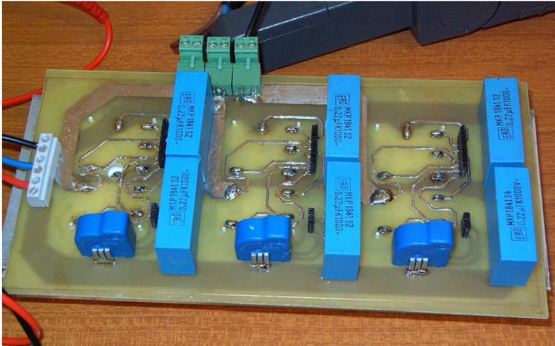
Figura 5.3. Parte de cima do conversor NPC
