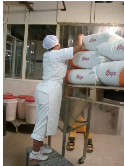
Ilustração 56 Operação de enchimento do silo
