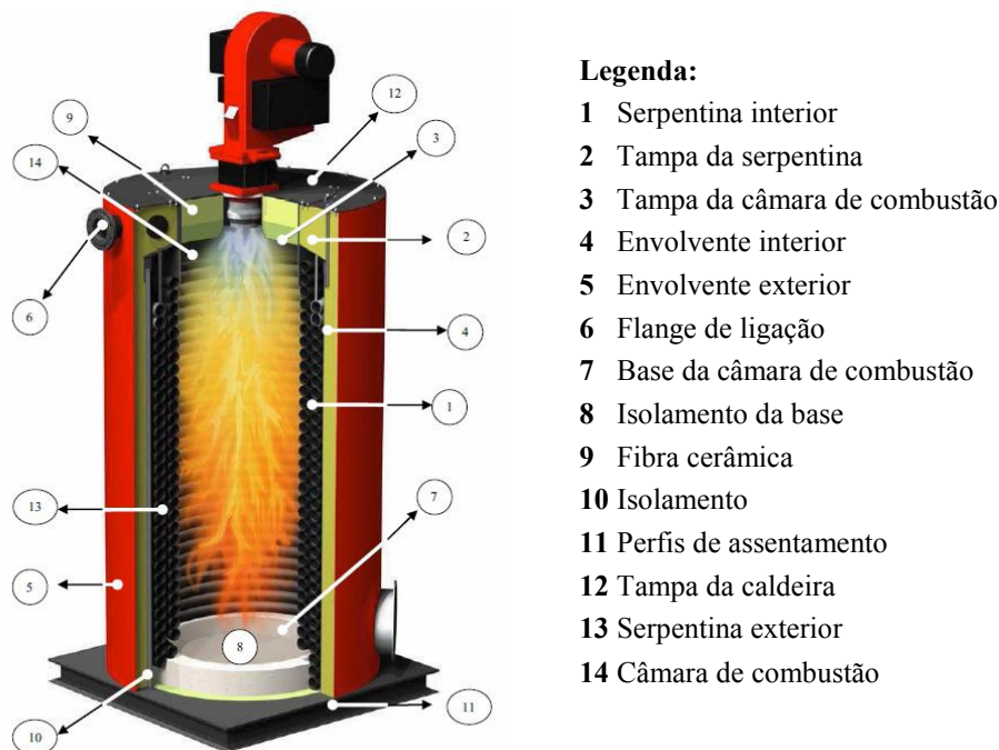
Figura 3.1 - Caldeira vertical de serpentina circular. “Imagem retirada do catálogo PIROBLOC”
