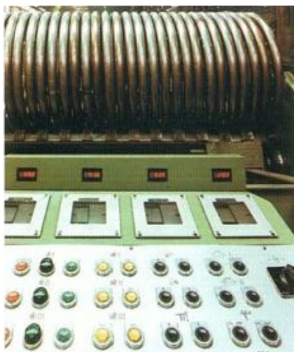
Figura 3.10 – Máquina onde efectuam-se testes técnicos a uma serpentina, de forma a garantir a sua resistência.
