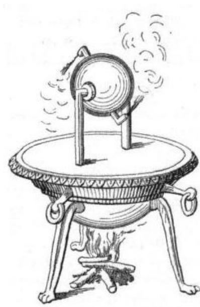
Figura 1 - Eolípila, máquina a vapor criada por Heron.
