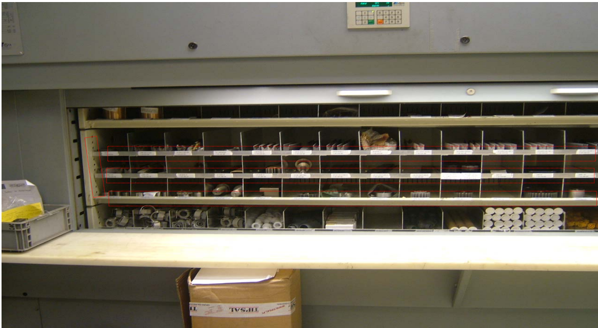
Imagem 1-Falta de identificação horizontal e vertical
