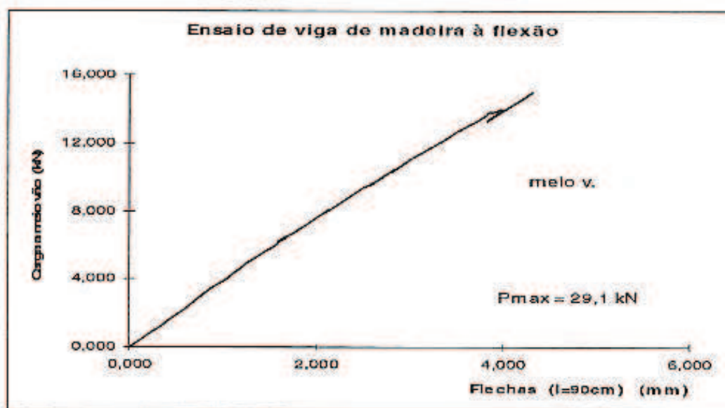
Fig.2.4 – Ensaio de viga de madeira à flexão (adaptado de Sarmento (2004))
