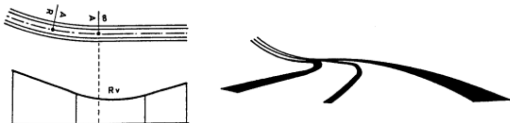
Fig.21 – Fim de curva em planta numa curva côncava.
