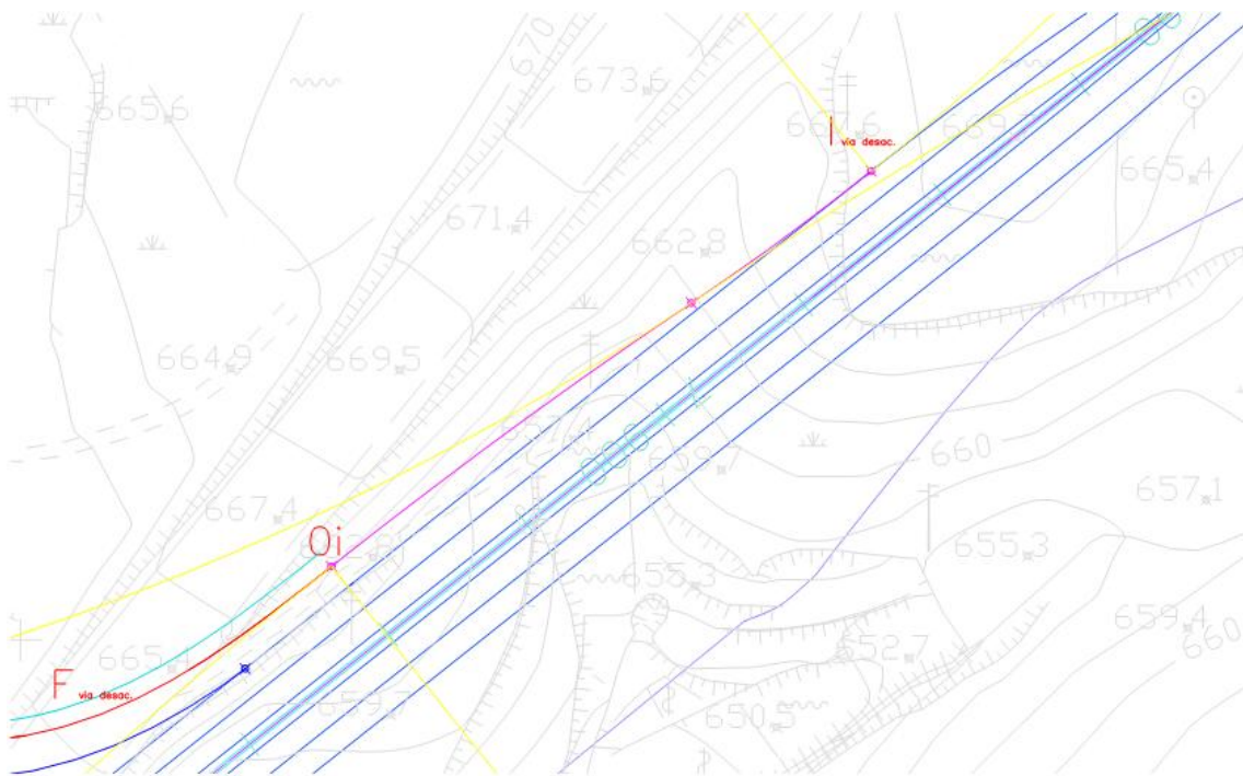
Fig.49 – Via de abrandamento associada ao Ramo A.
