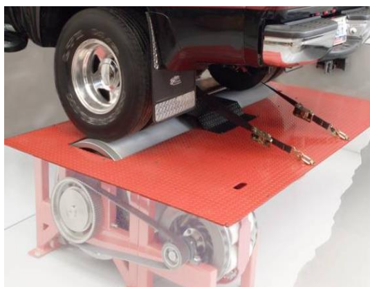
Figura 1-6 - Dinamômetro de chassis [2]
