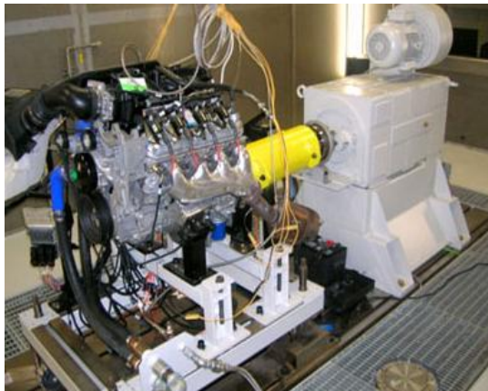
Figura 1-4 - Dinamômetro de motores [1]
