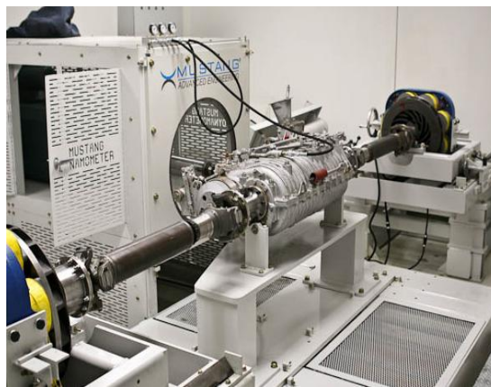
Figura 1-5 - Dinamômetro de transmissões [1]
