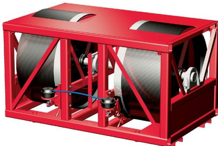
Figura 3-2 - Sistema com um só rolo de sustentação [21]
