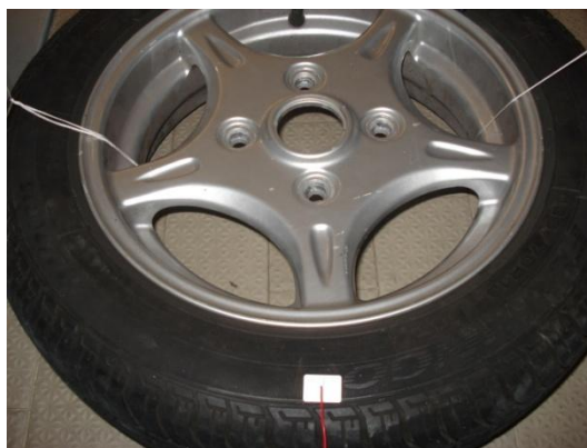
Figura Anexos-11 - Referência para verificação da frequência de rotação da roda
