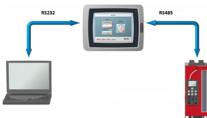
Figura 5-31 - Ligações da consola ao drive e PC
