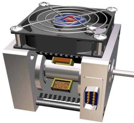
Figura 2-19 - Travão com arrefecimento por convecção [15]
