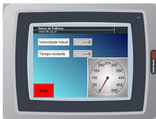
Figura 5-26 - Painel com informação do motor
