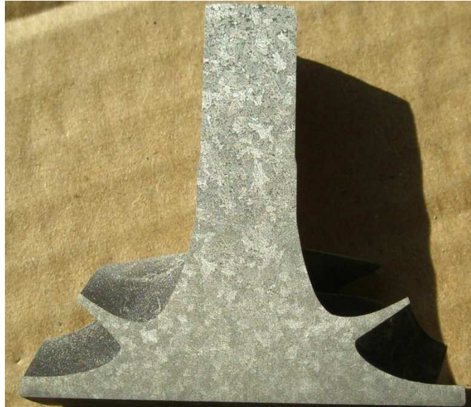
Figura 20 - Macroestrutura da liga 354.0 no estado bruto de vazamento (Keller).
