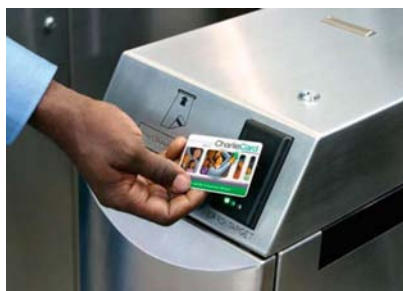
Figura 3.13 – Leitor fixo dum sistema de controlo de acessos físico
