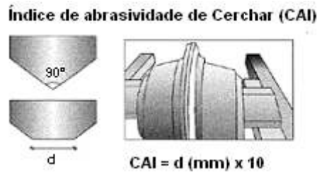
Fig. 3.22 – Determinação do Índice de Abrasividade de Cerchar (CAI) [36]
