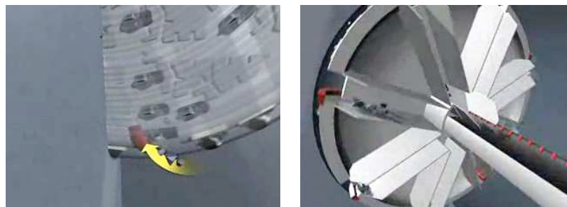
Fig. 2.15 – Extracção dos produtos de escavação [15]
