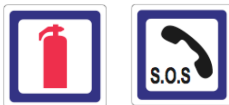
Fig. 5.15 – Sinalização dos equipamentos disponíveis nos postos de emergência [55]
