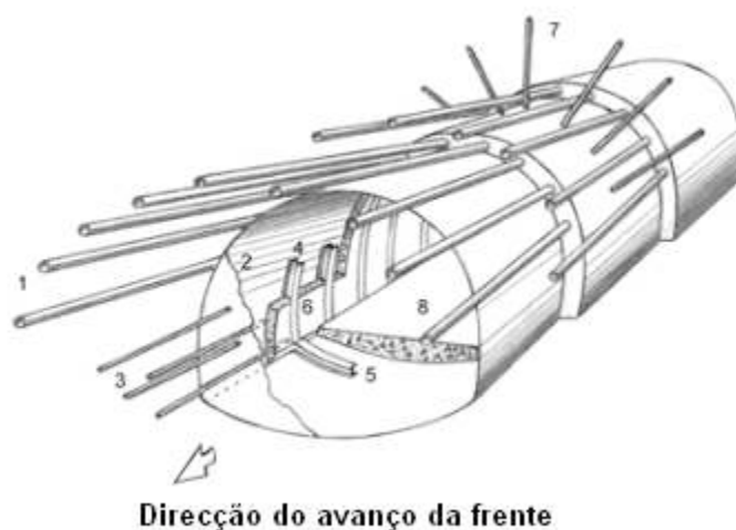
Fig. 2.6 - Tipos de suporte utilizados nos métodos convencionais, adaptado de Hoek [9]
