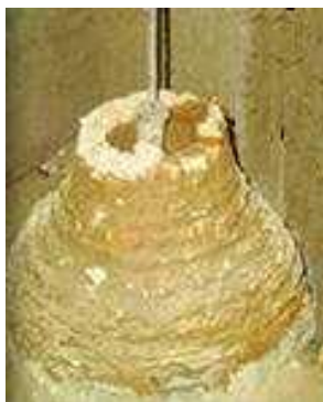
Figura 2.3 – Núcleo do molde em execução [1].
