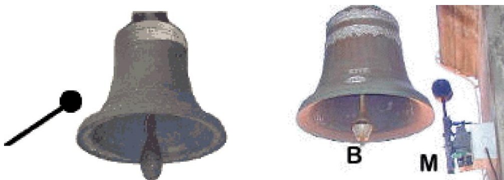
Figura 2.17 – Matraquear um sino manualmente (à esq.) e electricamente (à dir.) [1].
