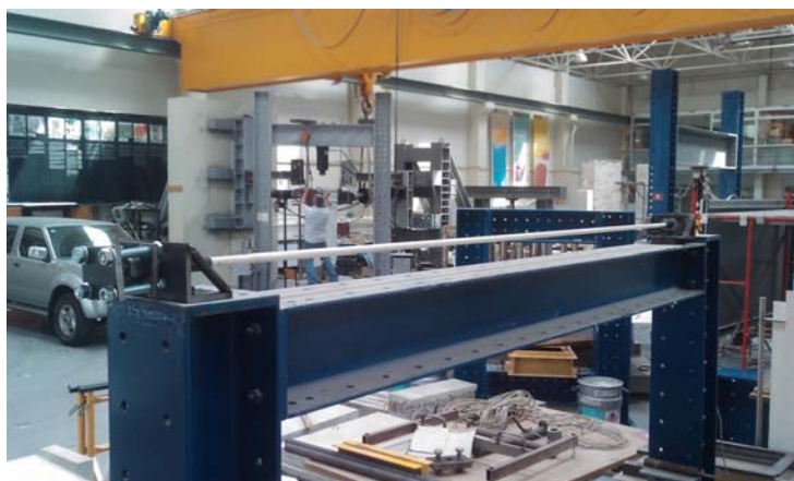
Figura 4.3 – Sistema de apoio
