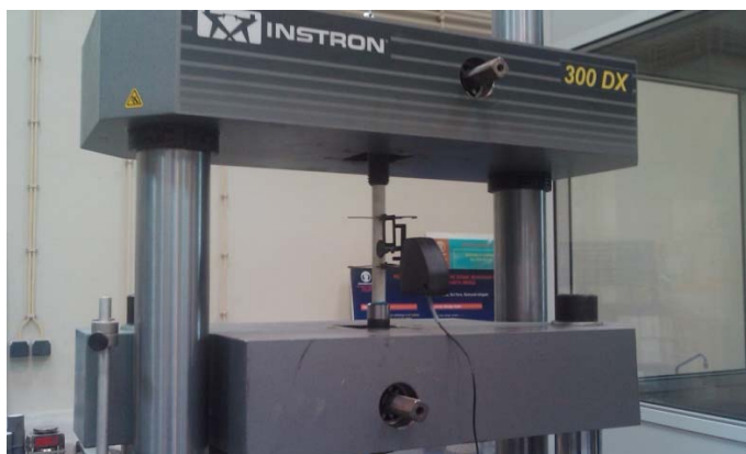
Figura 3.6 – Vista geral do ensaio de tracção uniaxial dos modelos de GFRP.
