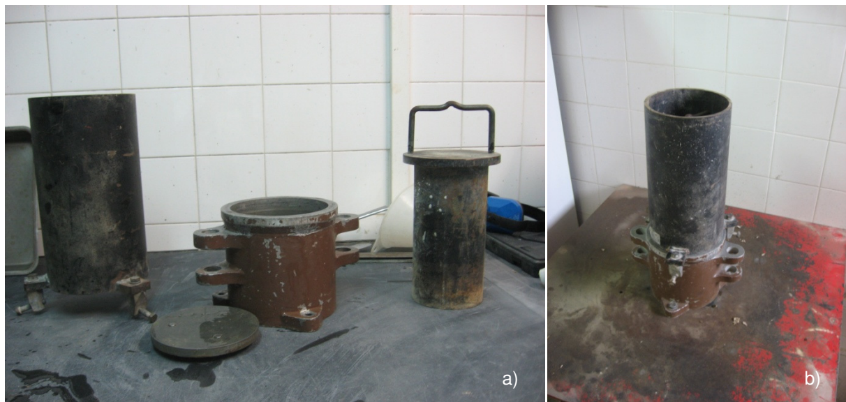
Fig.4.25 – a) Equipamentos: aguela, molde e peso; b) mesa vibratória.
