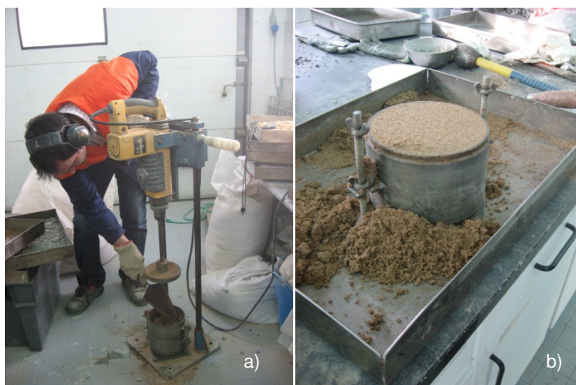
Fig.4.28 – a) Colocação do material no molde; b) Material no final da compactação.
