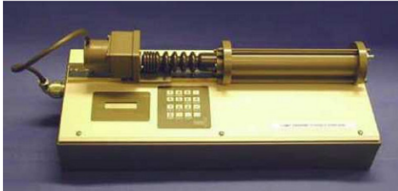
Fig.4.2 – Controlador de pressão GDS (GDS Instruments, 2001).
