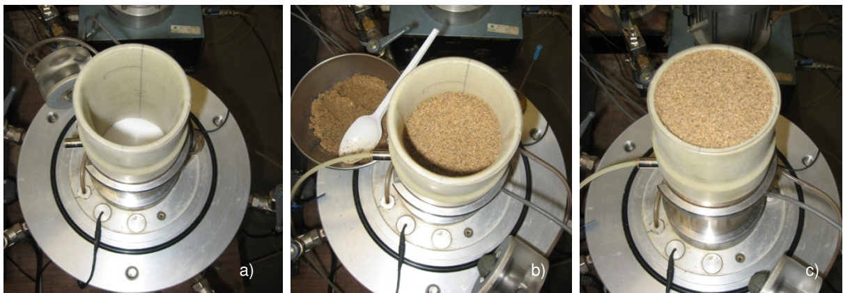
Fig.4.16 – a) ajuste da membrana ao molde; b) introdução de uma camada de areia; c) fase final da colocação da areia no molde.
