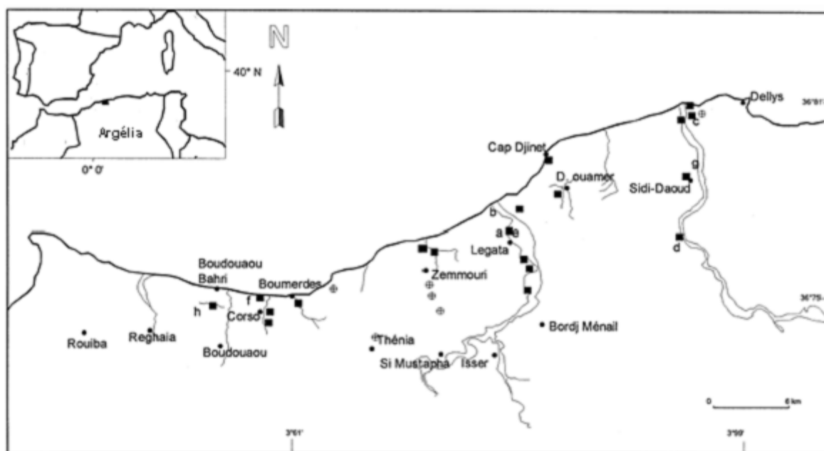
Fig.3.3 – Regiões onde se verificou o fenómeno de liquefacção durante o sismo de 21 de Maio de 2003, Argélia (Bouhadad et al, 2004).
