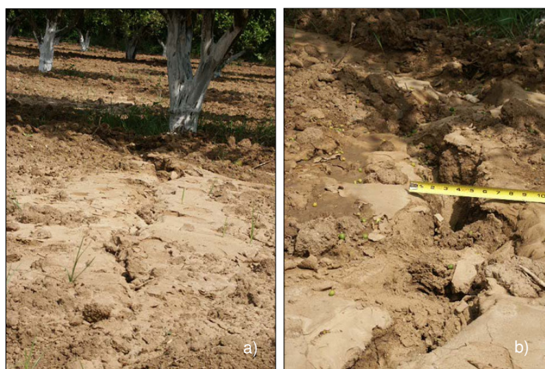
Fig.3.5 – a) Erupções de areia, sand boils , registadas após o abalo; b) Pormenor das sand boils (EERI,2003).
