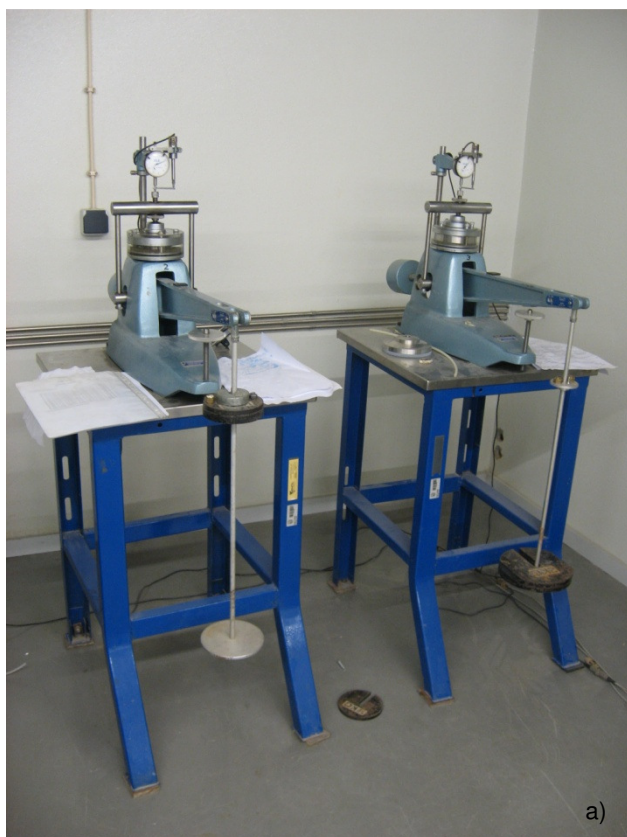
Fig.4.22 – a) edômetros; b) caixa e anel de 50mm; c) caixa e anel de 75mm.
