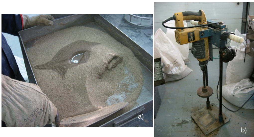
Fig.4.27 – a) Preparação da amostra; b) Martelo Kango.
