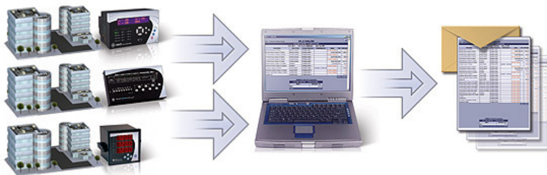
Figura 8 – Esquema de um PMCS, Sistema de controlo de gestão de energia
