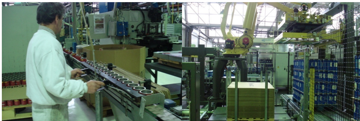
Figura 4 – Paletização manual x Paletização por robô
