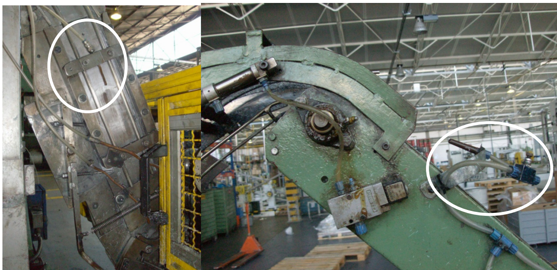
Figura 24 – Sopro de ar comprimido para movimentação de componentes
