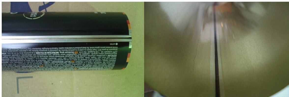
Figura 1 – Embalagem pronta para processo de cravamento de fundo e cúpula
