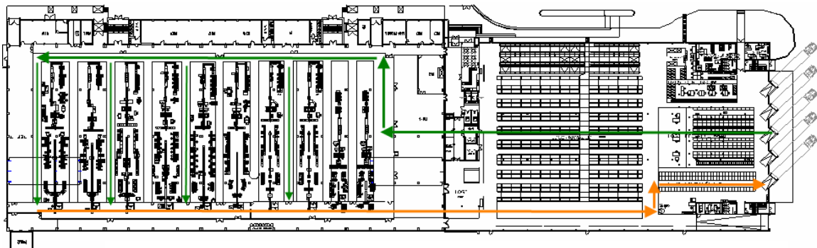
Figura 6 – Fluxo de material na fábrica e armazém principal
