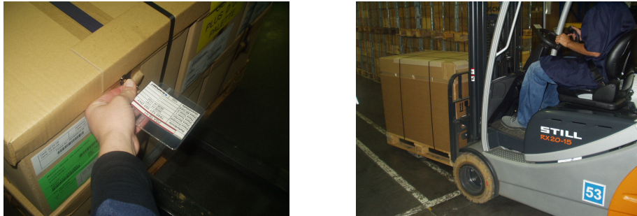
Figura 10 – Retirar Kanban da paleta e levantar paleta
