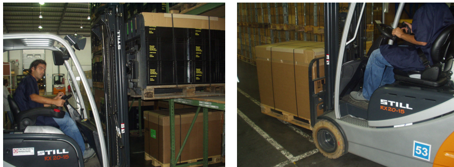
Figura 16 – Retirar palete da estante e colocar na zona de carga
