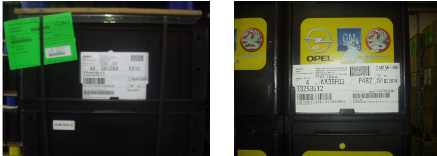
Figura 22 – Colocação de etiquetas VDA e sub-HU's em paletes Opel
