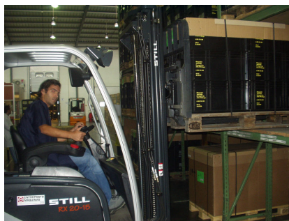
Figura 12 – Colocação de paleta na estante
