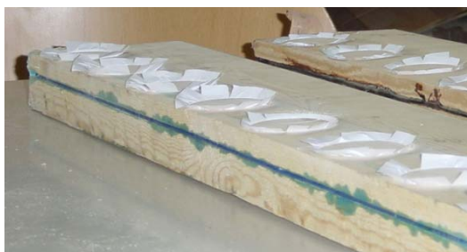
Figura 3.2 – Provetes para ensaio de “Pull-Off” ajustados à técnica NSM (Vidal Ferreira e Juvandes, 2006).
