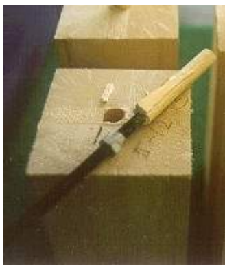
Figura 5.10 – Ensaio “Pull-Out” de Tomasi (1999) donde Musner (2004) determinou \beta=0.237 .
