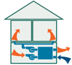
Figura 7 - Pressões equilibradas numa habitação
