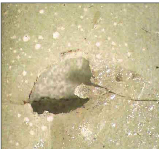
Figura 1.13 Provete testado à tracção com um vazio resultante da evaporação do monómero (MMA).
