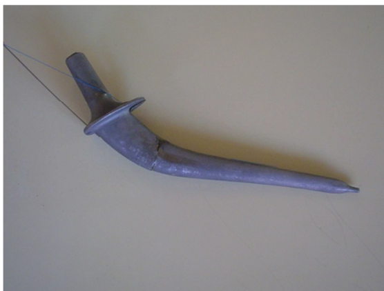
Figura 1.18 Componente femoral da prótese de anca com a fissura e a fibra óptica.
