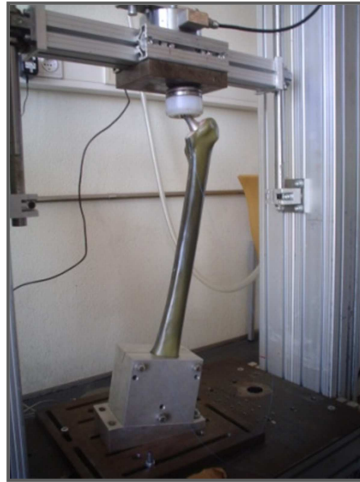
Figura 1.29 Máquina e set-up utilizados para os ensaios de fadiga do protótipo laboratorial de uma haste femoral com oito redes de Bragg.
