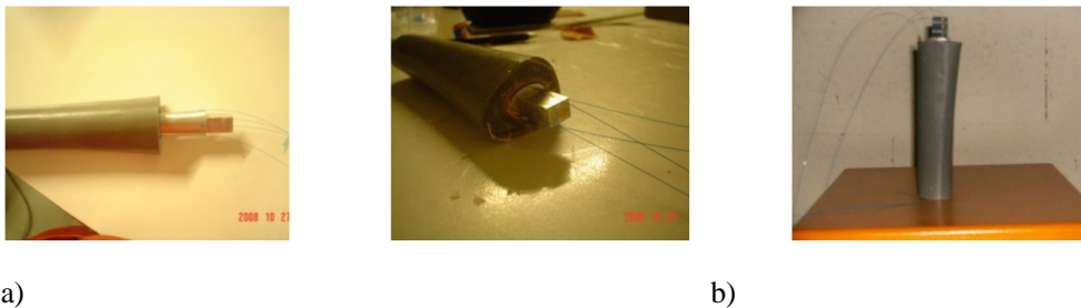
Figura 1.22 a) Modelo simplificado da geometria de uma haste femoral em alumínio e um bloco em resina; b) modelo simplificado fixado com cimento ósseo (PMMA) no bloco de resina como suporte (simulando um fémur sintético).
