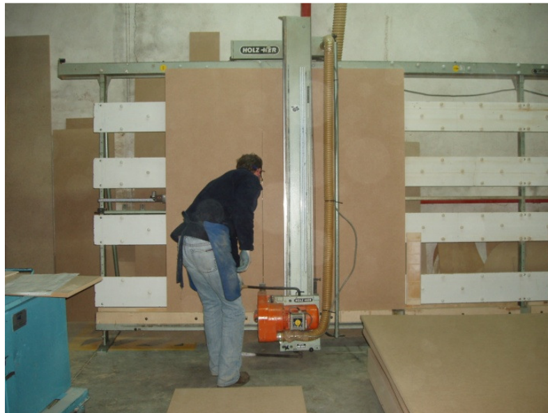
Fig. 83 - Operador a utilizar equipamento de corte de placa.
