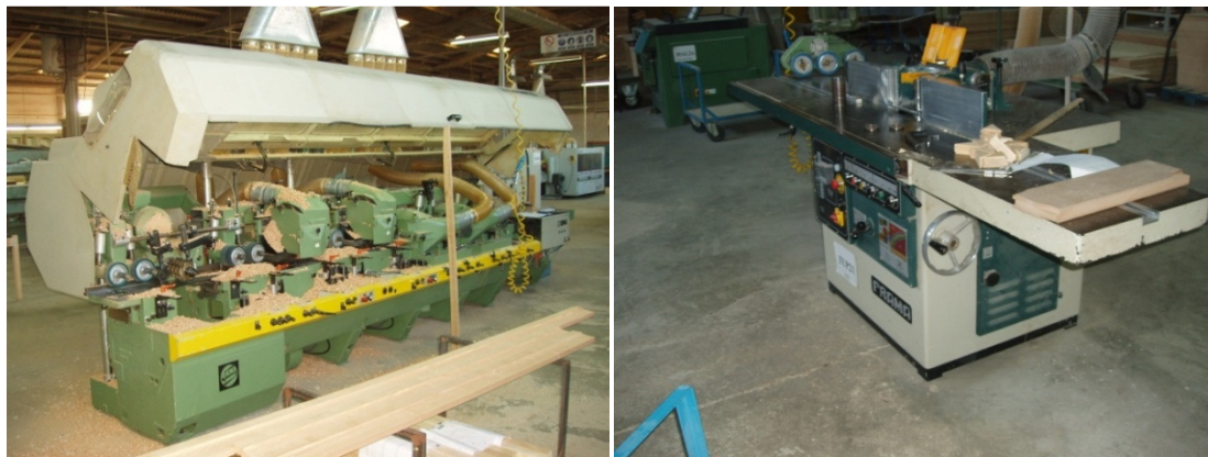
Fig. 79 – À direita Vista geral do interior da molduradora, à esquerda vista geral de uma tupia.
