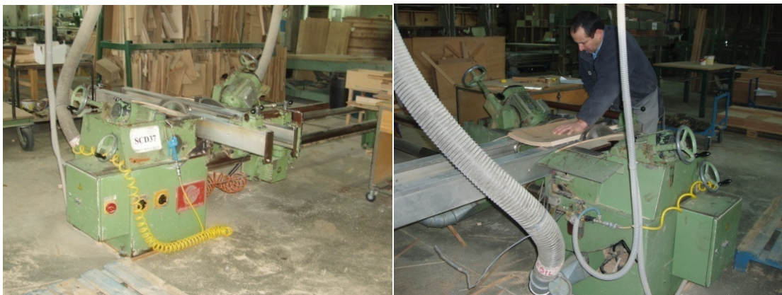
Fig. 77 – À esquerda imagem geral da multi-serra circular, à direita equipamento em utilização.
