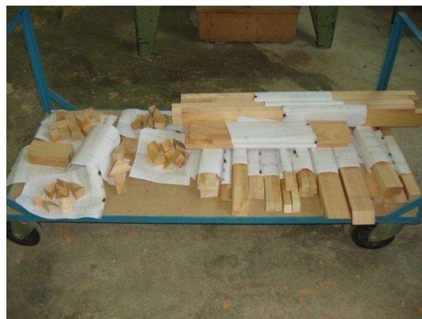
Fig. 78 - Lote dos componentes após topear e galgar.
