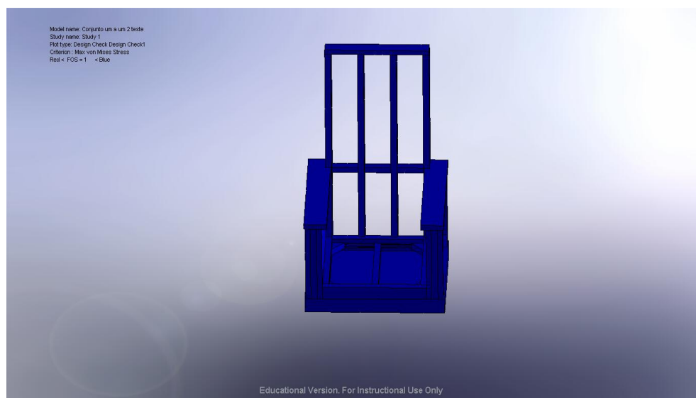
Fig. 65 - Distribuição do coeficiente de segurança no casco da cadeira obtida com o Cosmoworks do Solidworks 2008
