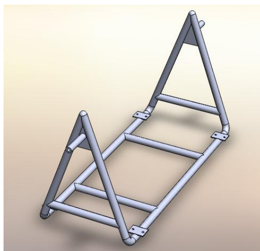
Fig. 45 - Vista geral da estrutura de aço inox da cadeira
