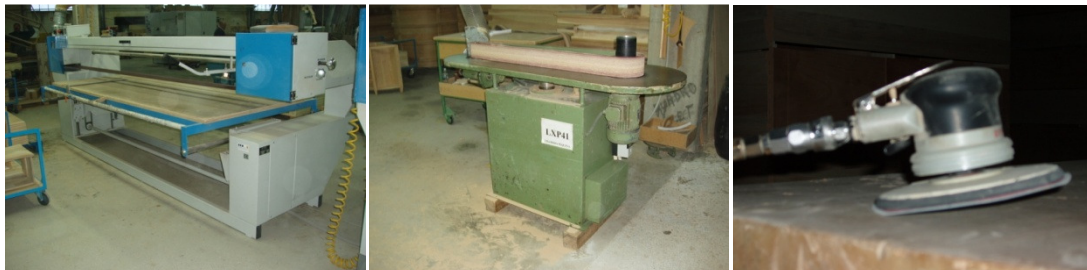
Fig. 82 – Da direita para a esquerda vista geral da lixadeira grande, à esquerda vista geral de uma lixadeira pequena e por fim lixadeira manual.
