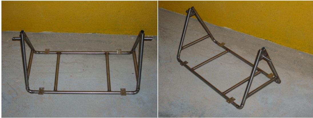
Fig. 87 – Vista geral da estrutura de aço da cadeira.
