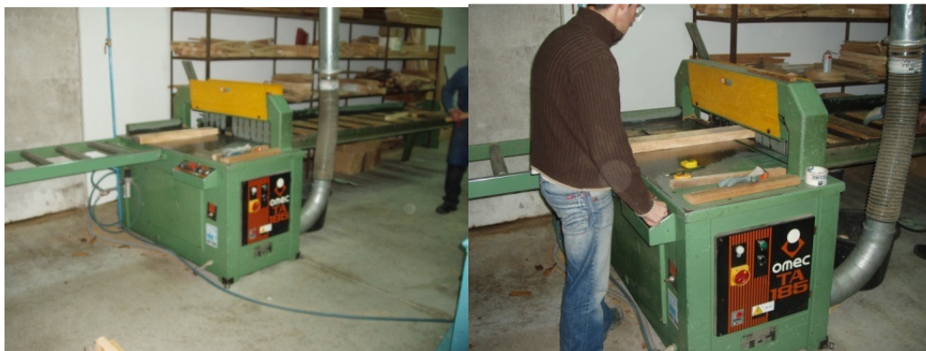
Fig. 72 - À esquerda imagem geral a equipamento de traçar madeira, à direita operador a utilizar o equipamento
