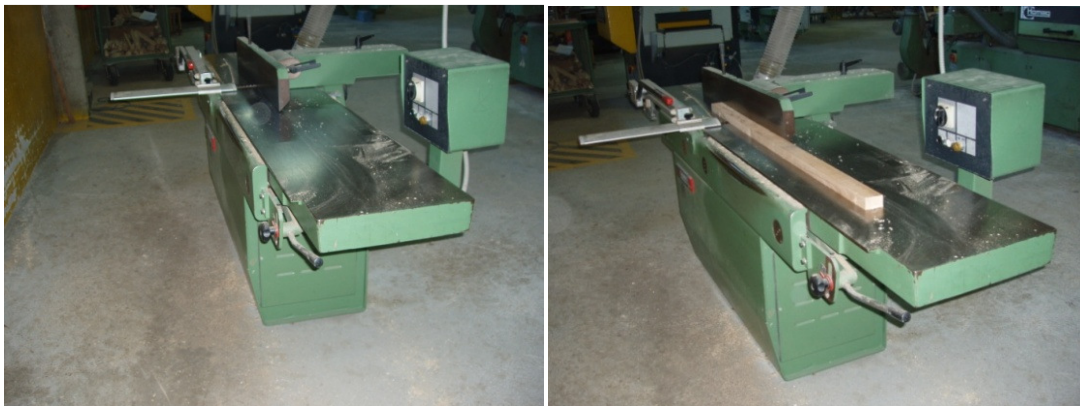
Fig. 75 – A esquerda imagem geral da garlopa, à direita equipamento em utilização.
