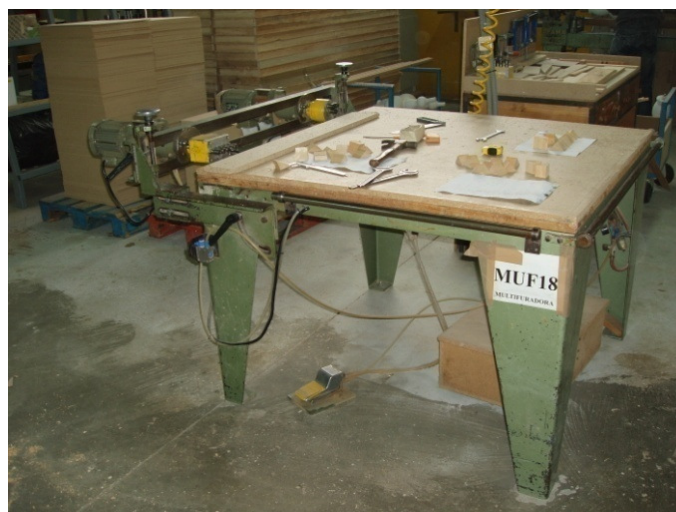
Fig. 80 – Vista geral da multi-furadora.
