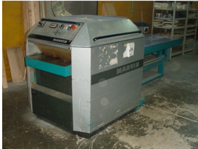
Fig. 76 - Imagem geral da maquina de desengrossar.
