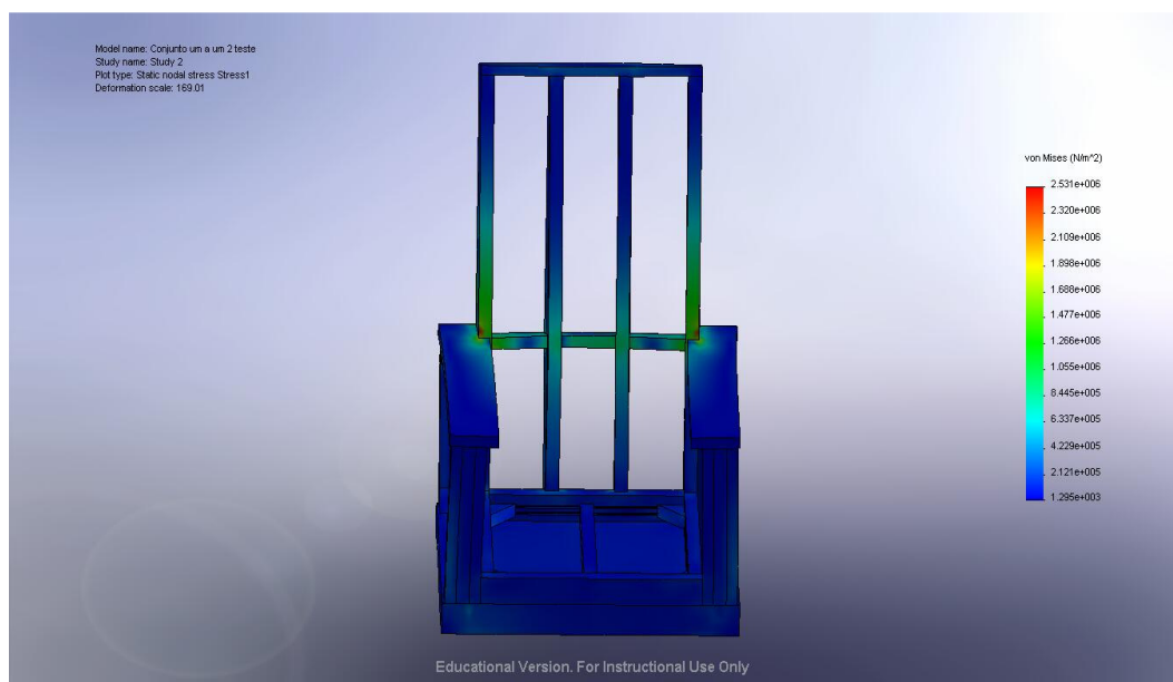
Fig. 66 - Distribuição da tensão de von Mises no casco da cadeira obtida com o Cosmoworks do Solidworks 2008
