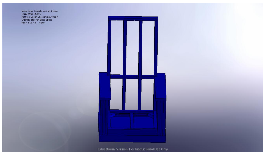
Fig. 68 - Distribuição do coeficiente de segurança no casco da cadeira obtida com o Cosmoworks do Solidworks 2008
