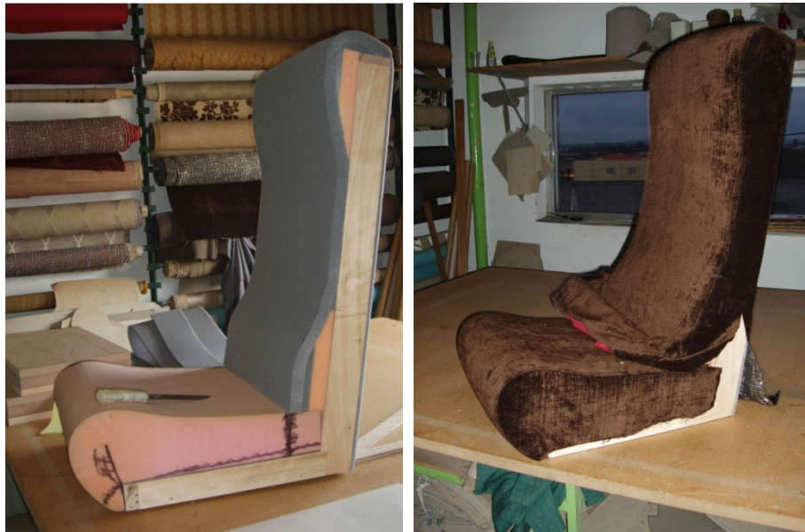
Fig. 91 – À esquerda o casco sendo preenchido com espuma, à direita o casco sendo coberto de tecido.
