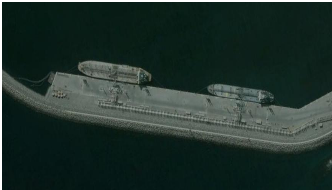
Fig. 4.19: Porto de Fujairah. Ilustração do cais contínuo do porto de Fujairah.
