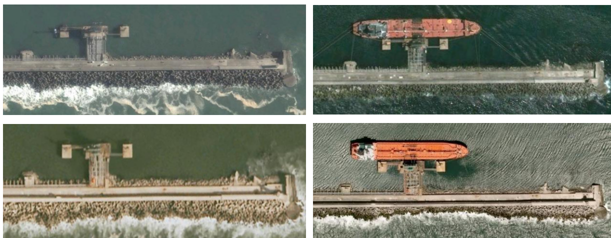
Fig. 3.5: Esquema da deteriorização do quebramar. Esquerda Cima: 2003; Direita Cima: 2004; Esquerda Baixo: 2006; Direita Baixo: 2009.
