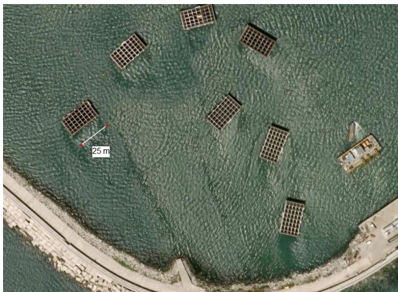
Fig. 4.27: Caixotões utilizados na construção do molhe Norte da Foz do Douro.
