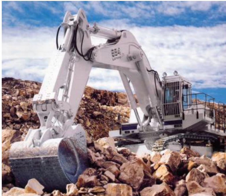
Fig. 5.7: Escavadora Hidráulica Liebherr 984 – [29].
