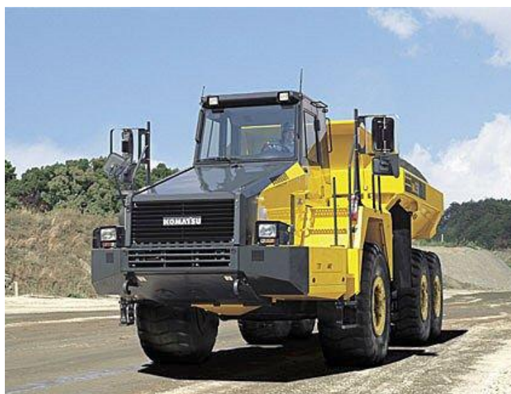
Fig. 5.6: Dumper Articulado Komatsu HM400-2 : 24 040kg - 69 040kg – [28].
