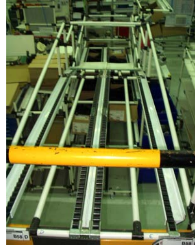
Figura 4.1 - Estrutura de ligação (ponte) - B58
