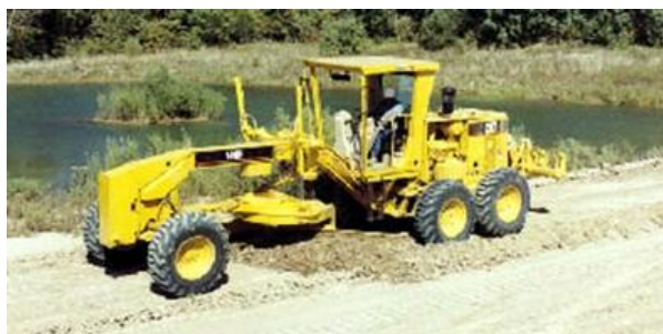
Figura 9. Fotografia de uma moto niveladora, tem a função de nivelar a plataforma.
