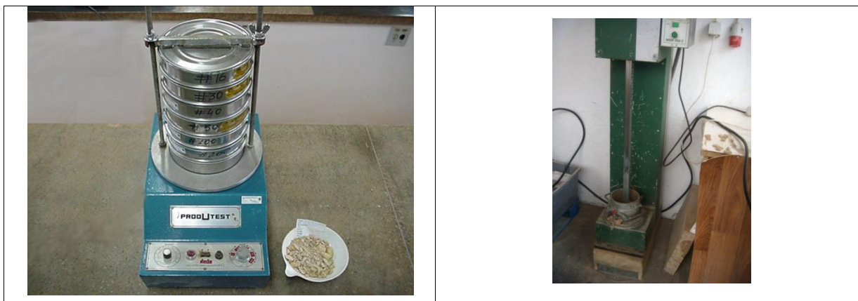
Figura 19. À esquerda aspecto de peneiração com recurso a um peneirador mecânico [25]; à direita aspecto da compactação com o pilão pesado do Proctor.
