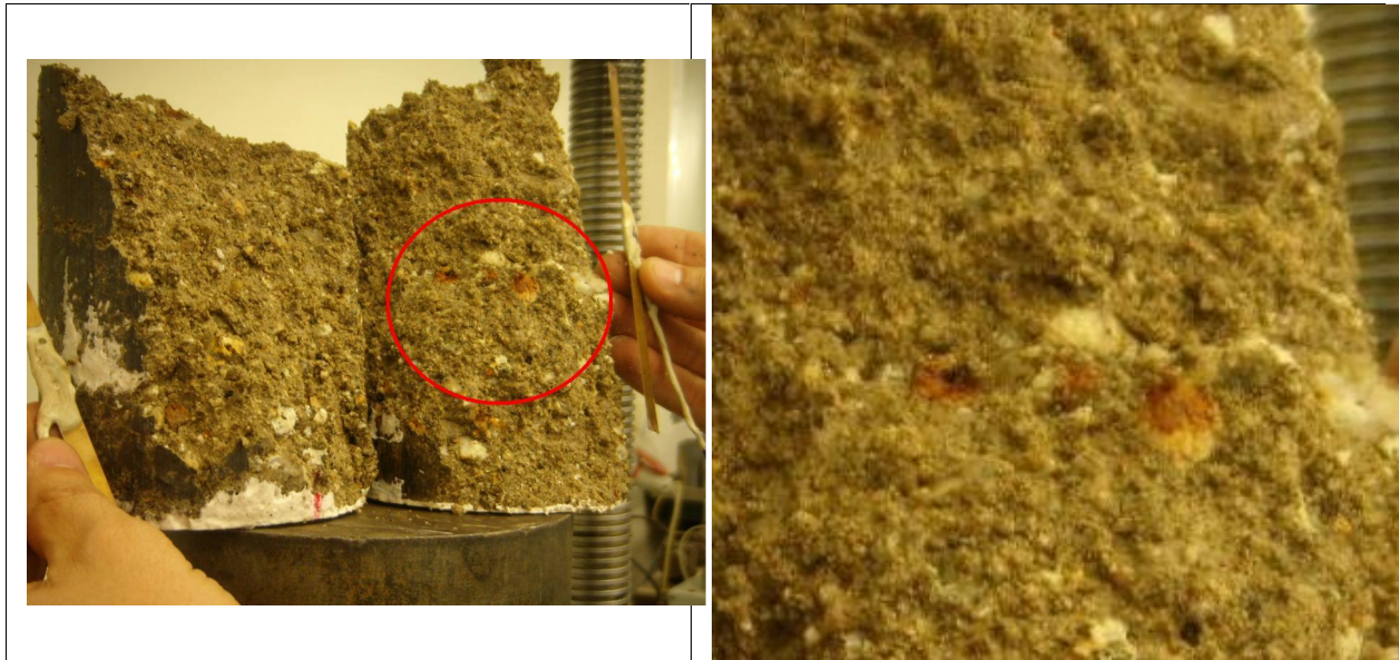
Figura 25. Vista do interior do provete após a rotura.
