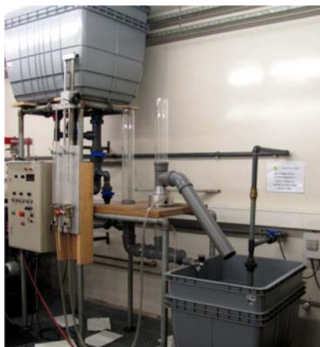
Figura 3.49 – Equipamento de ensaio de permeabilidade à água normal ao plano do LGS da FEUP.
