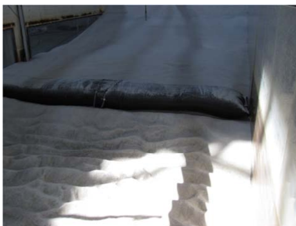
Figura 4.1 – Modelo reduzido de fundo móvel para ensaio de um geotubo submerso.
