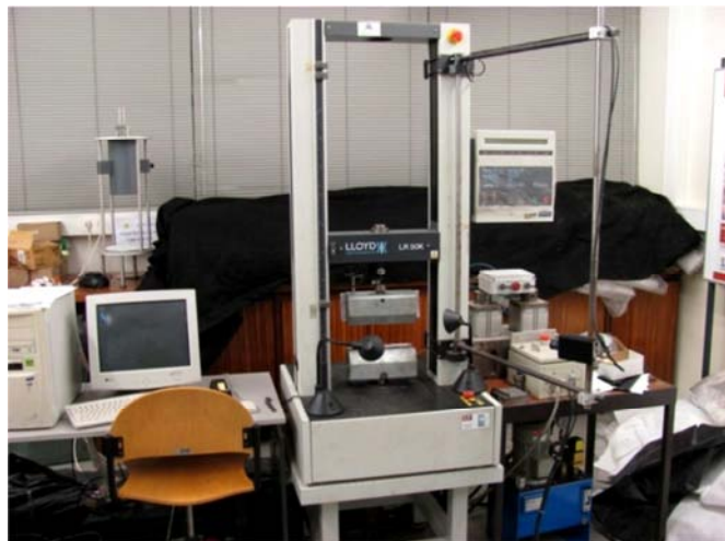
Figura 3.13 – Equipamento de ensaio universal do laboratório de geossintéticos.
