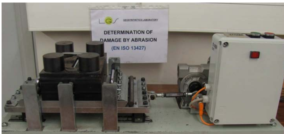
Figura 3.72 – Equipamento de abrasão desenvolvido para o Laboratório de Geossintéticos.
