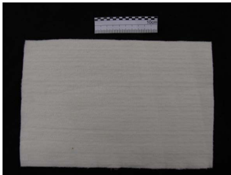
Figura 3.63 – Proвете do geotêxtil GTP preparado para o ensaio de permeabilidade à água no plano.
