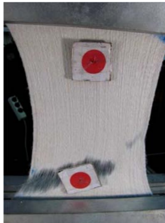
Figura 3.19 – Rotura de geotêxtil GTP com deslocamento do alvo.
