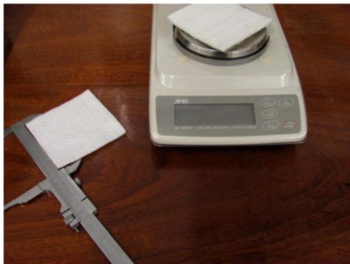
Figura 3.11 – Determinação da massa por unidade de área: medição e pesagem do provete geotêxtil.
