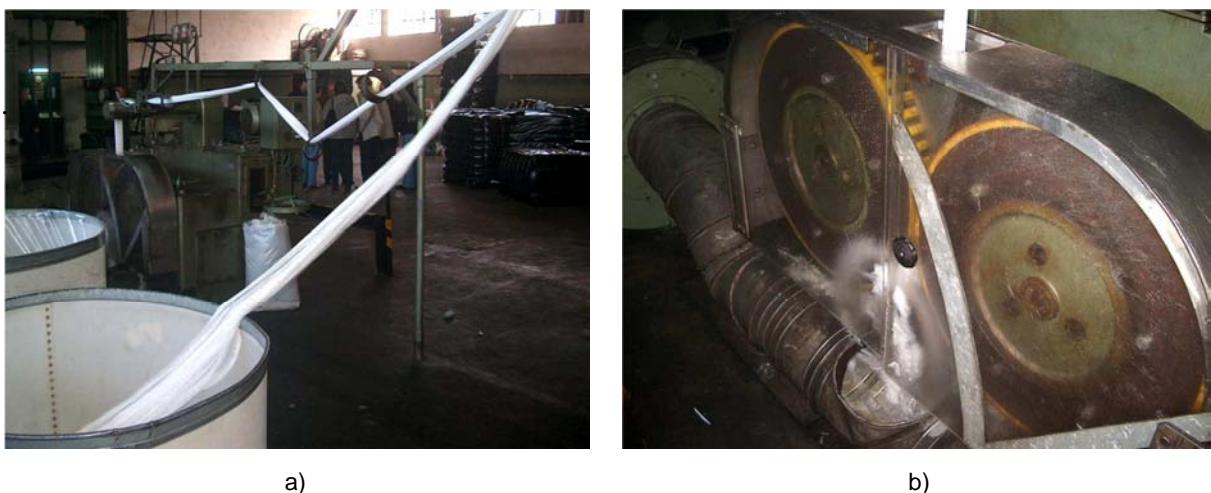
Figura 3.5 – Processo de corte dos monofilamentos de PP: a) vista geral do processo; b) pormenor do sistema de corte e de recolha das fibras (Carneiro, 2009).
