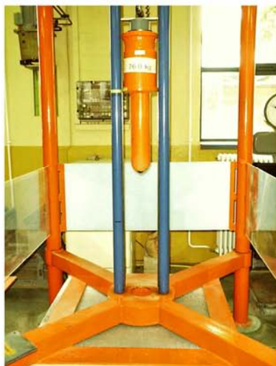
Figura 4.4 – Dispositivo de simulação do punçoamento dinâmico (adaptado de Heibaum, 2010)
