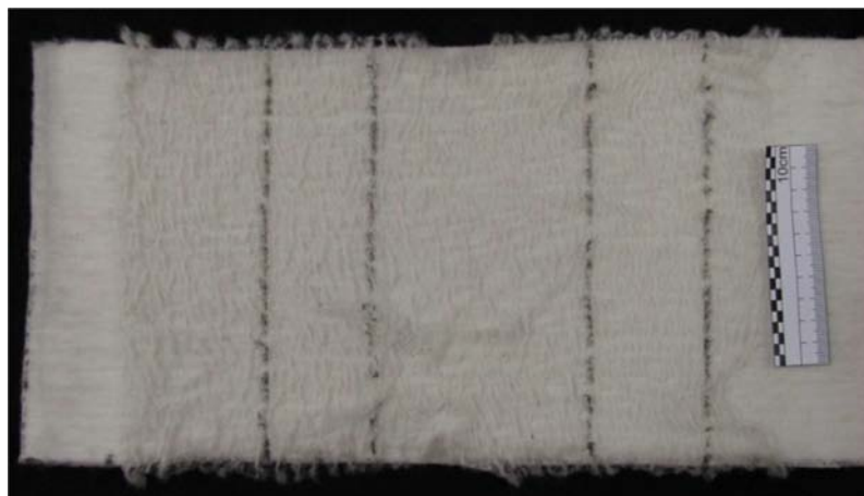
Figura 3.78 – Proвете sujeito à abrasão preparado para corte e ensaio à tracção.
