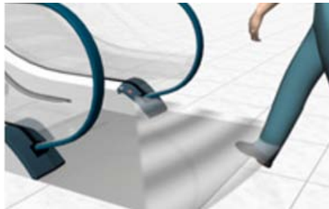
Figura 3.9 – Pormenor de um sensor ultra-sónico de aproximação numa escada rolante [34].
