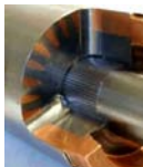
Figura 2.8 - Pormenor de um rotor em cobre [16].
