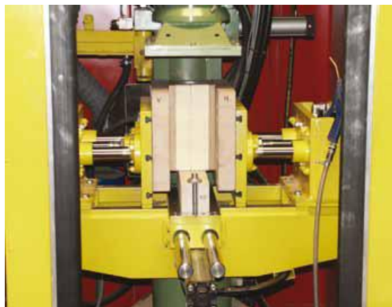
Figura 2.2 - Câmara interior duma disparadora de machos.
