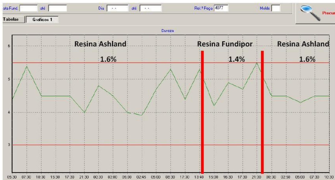
Gráfico 4.9 - Variação da dureza superficial do macho referência 4077 em função de adição de resina (parte 1 + parte 2) sistema Clássico (resina Ashland) e da resina sistema Biodiesel (resina Fundipor).
