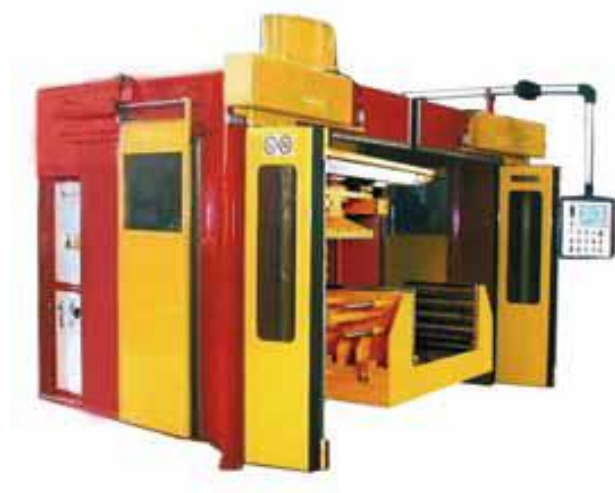
Figura 2.1 - Máquina disparadora de machos com capacidade de 100 litros.
