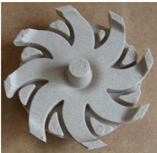
Figura 2.3. Macho produzido pelo processo caixa fria.
