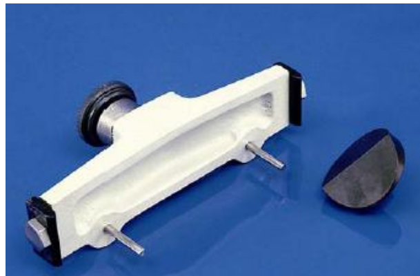
Figura 3.3 - Mordaza de sustentação de provetes para ensaios de resistência à flexão.
