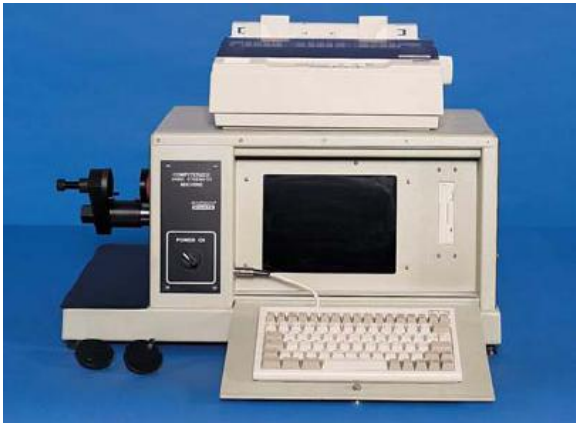
Figura 3.2 - Máquina universal de ensaios de areia computadorizada.
