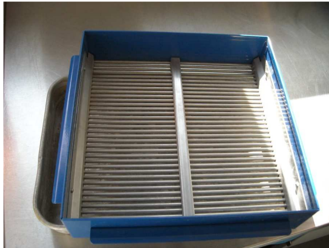
Figura 14 - Aspecto de um peneiro de barras utilizado na realização do ensaio
