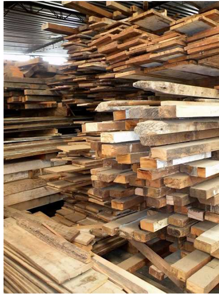
Figura 4 - Madeira resultante de uma demolição selectiva
