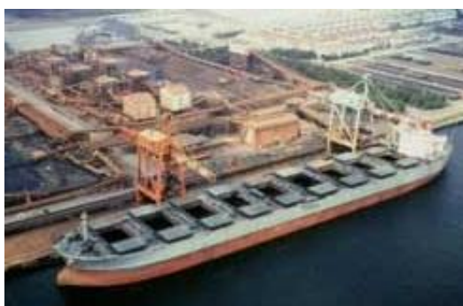
Figura 2.13 - Exemplo de carga de um navio graneleiro
