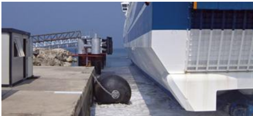
Figura 2.10 - Exemplo de defesa pneumática flutuante
