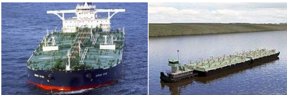
Figura 2.22 - Embarcações com bordo baixo
