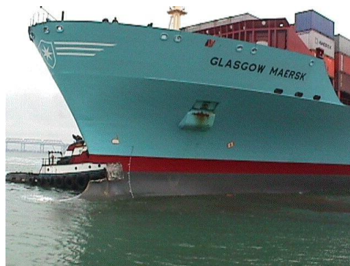
Figura 2.43 - Exemplo de danos provocados por uma colisão frontal de um navio com o cais no porto de Oakland nos Estados Unidos da América
