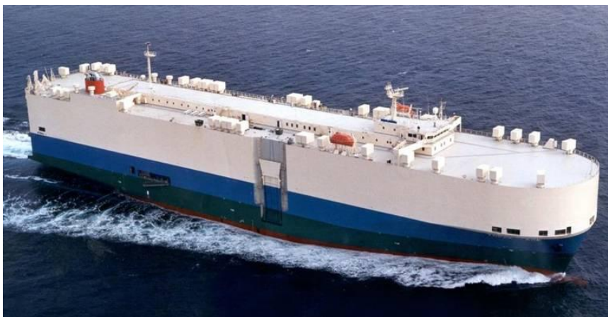
Figura 2.23 - Navio Ro-Ro com bordo alto
