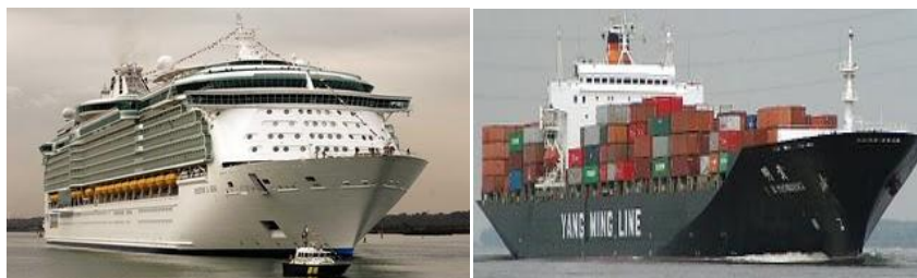
Figura 2.19 - Exemplos de navios com proa arredondada
