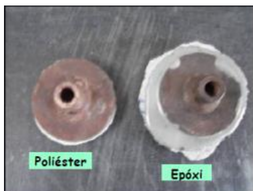
Fig. 16 – Provetes após ensaio de arrancamento sem aplicação de pré-corte. Comparação entre secção extraída com a aplicação de cola de poliéster e cola epoxy
