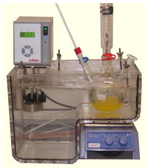
Figura 9: Reactor imerso no banho termoeestático [32].
