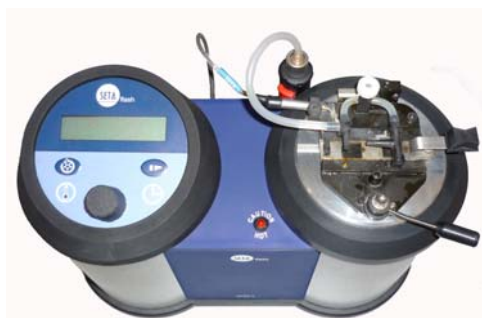
Figura 12: Equipamento utilizado para a determinação do ponto de inflamação.
