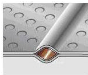
Fig. 17 – Placa de absorção por canais e com tubo de secção oval
