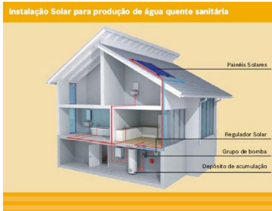
Fig. 15 – Exemplo de uma instalação solar térmica
