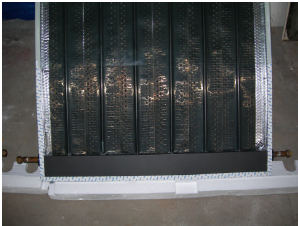
Fig. 138 – Protótipo CST ar140 – detalhe das alhetas
