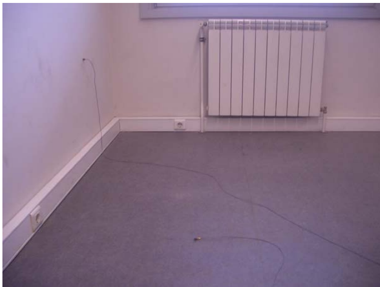
Fig.5.8 - Colocação dos acelerómetros
