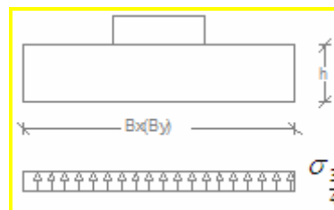
Fig. 31 – Carregamento da sapata e diagrama de momentos (KNm/m)
