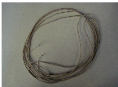
Figura 3.5 - Resistência para aquecimento do percurso de tubagem de 1/16 polegadas de diâmetro, que estabelece a ligação ao cromatógrafo de fase gasosa.
