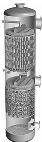
Figura 3.20 - Representação esquemática duma coluna de destilação de enchimento.
